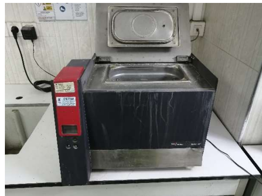
Figure AI.11 : Bain marie à une température de 100 °C
