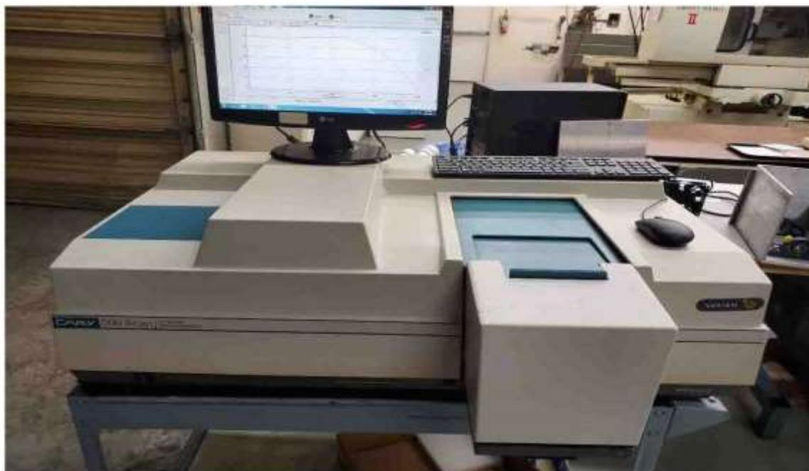
Figure III. 15: Spectrophotomètre d'absorption UV-Visible.
