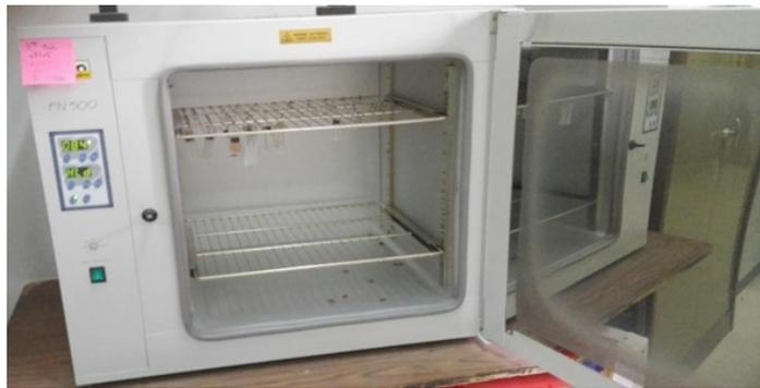
Figure III.4 : Etuve pour le vieillissement thermique.
