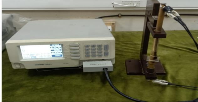
Figure III.6. Impédance-mètre de type Gw Instek LCR-817.
