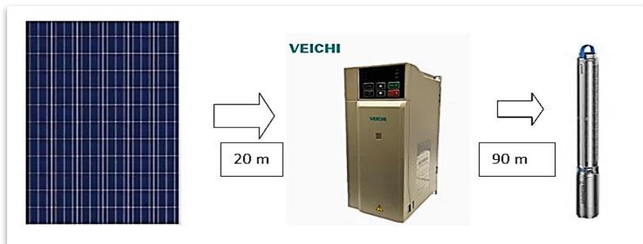
**Figure III. 10:** Schéma d'installation PV
