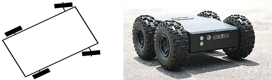
Figure I.7 : Images illustratives qui montrent un robot de type voiture [19, 22].
