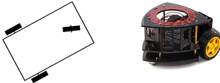
Figure I.6 : Images illustratives montrent un robot de type tricycle « Tricycle Bot » [19, 21].
