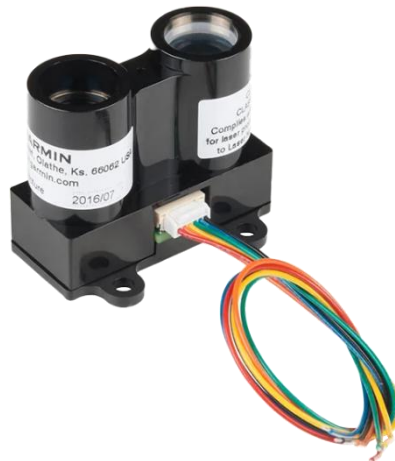
Figure II.8: image illustreun capteur lidar « LIDAR Lite v3 » [42].
