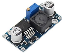
Figure II.10: image montre Le module abaisseur LM2596 [44].
