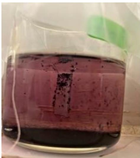
**Figure III. 8:** Acier immergé dans HCl avec inhibiteur après corrosion.
