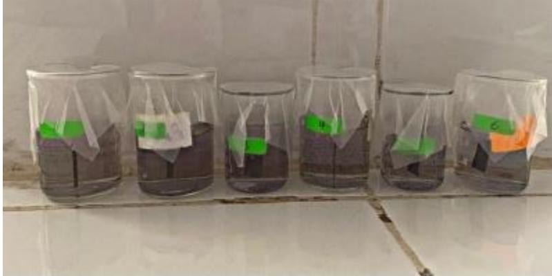
**Figure II. 11:**Échantillons avant la corrosion.
