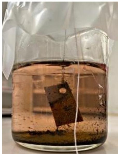
**Figure III. 11:** Acier immergé dans NaCl avec inhibiteur après corrosion.
