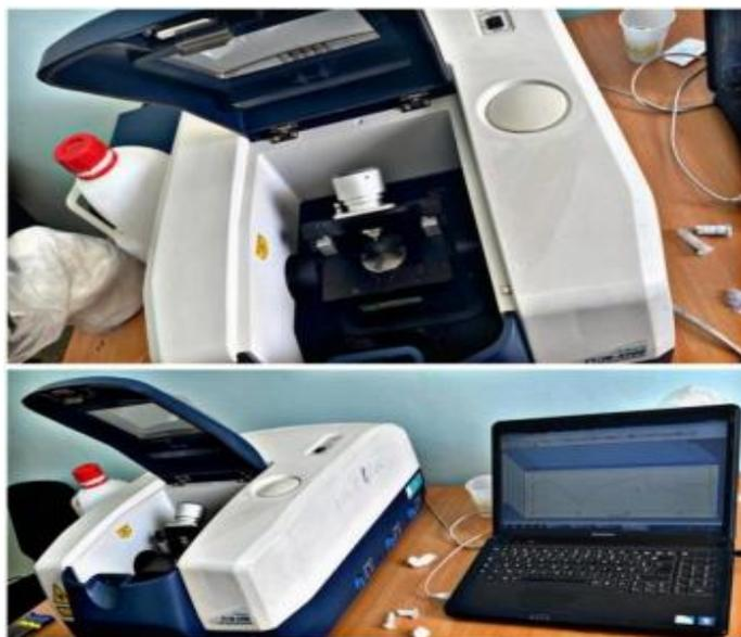
**Figure II. 6:**Spectromètre FTIR-4200 de JASCO.
