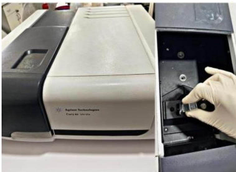
**Figure II. 7:**Spectrophotomètre UV-visible Cary 60 UV-Vis.
