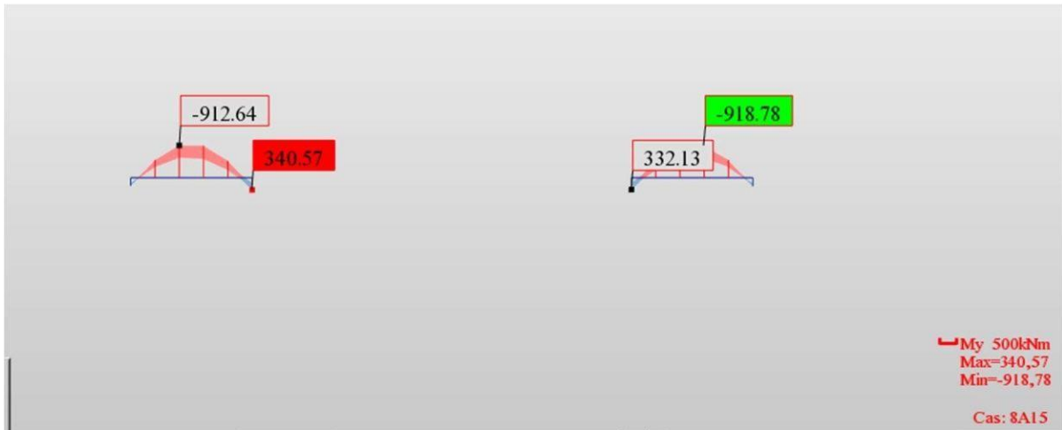
Figure VI-17 Moment des nervures au niveau appuis et travée (combinaison ELA)
