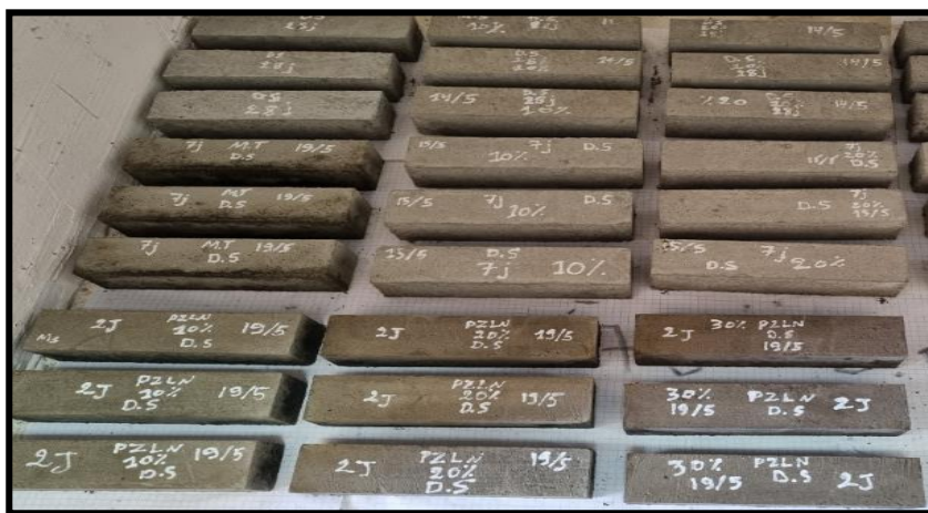
Figure II- 12 : Conservation des éprouvettes à l'air libre
