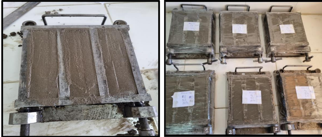
Figure II- 11 : Préparation et stockage des éprouvettes
