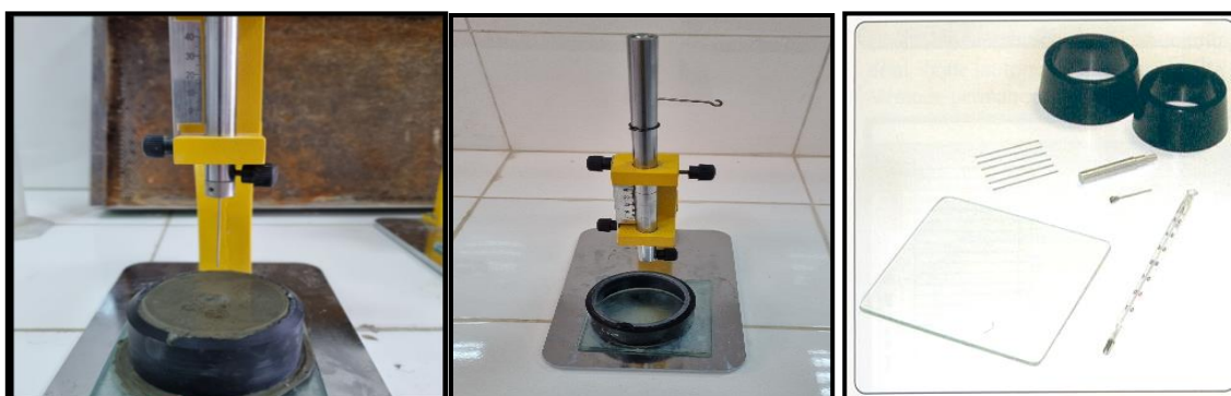
Figure II-10 : L'équipement d'essai de consistance
