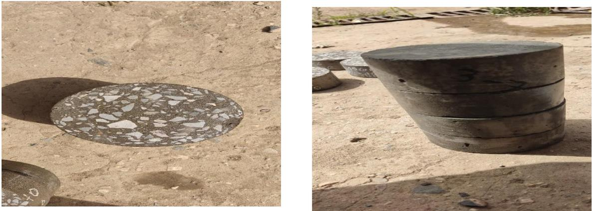
**Figure. IV. 9:** coupage des éprouvettes
