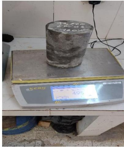
**Figure. IV. 6 :** éprouvette prête à l'essai de compression sur une balance précise
