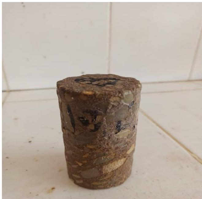
**Figure. IV. 20 :** éprouvettes du béton avec 15% de la vase calcinée refroidit à l'eau immergé dans la solution HCL
