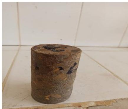
**Figure. IV. 18 :** éprouvette du béton avec 15% de la vase calcinée refroidit à l'air immergé dans la solution HCL
