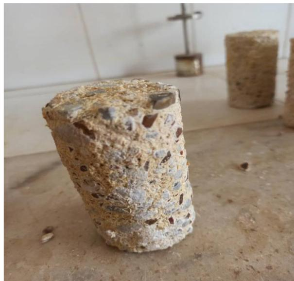
**Figure. IV. 25 :** éprouvette du béton avec 15% de la vase calcinée refroidit à l'air immergé dans la solution  $H_2SO_4$
