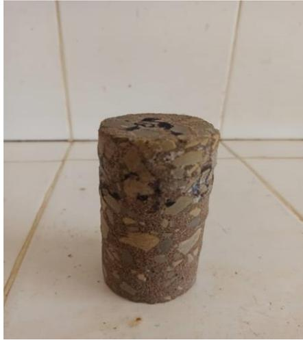
**Figure. IV. 16 :** éprouvette du béton témoin immergé dans HCL
