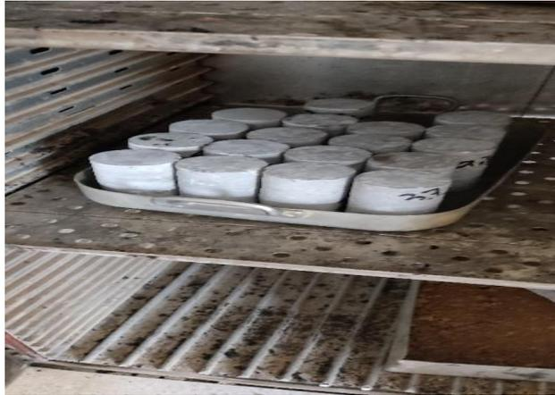
**Figure. IV. 14:** les éprouvettes dans l'étuve pendant 24h
