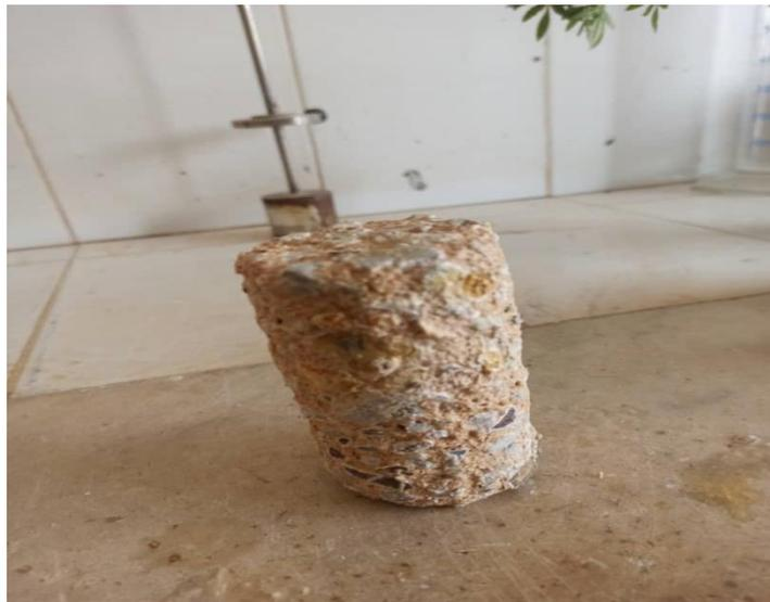
**Figure. IV. 27 :** éprouvette du béton avec 15% de la vase calcinée refroidit à l'air immergé dans la solution  $H_2SO_4$
