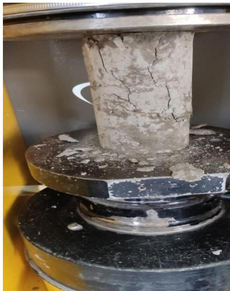
**Figure. IV. 7 :** éprouvette dans la presse après essai la compression
