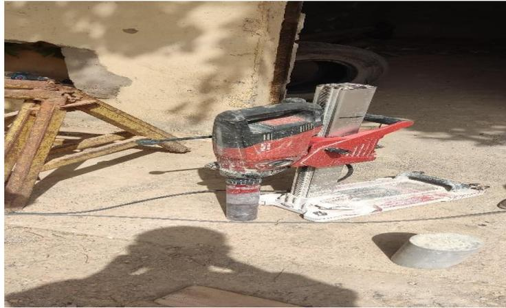
**Figure. IV. 11:** la machine utilise pour le carottage des éprouvettes
