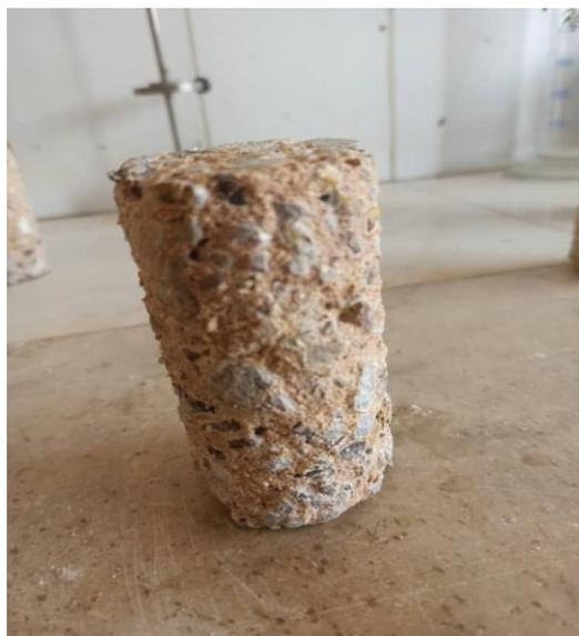
**Figure. IV. 23 :** éprouvettes du béton témoin immergé dans la solution  $H_2SO_4$
