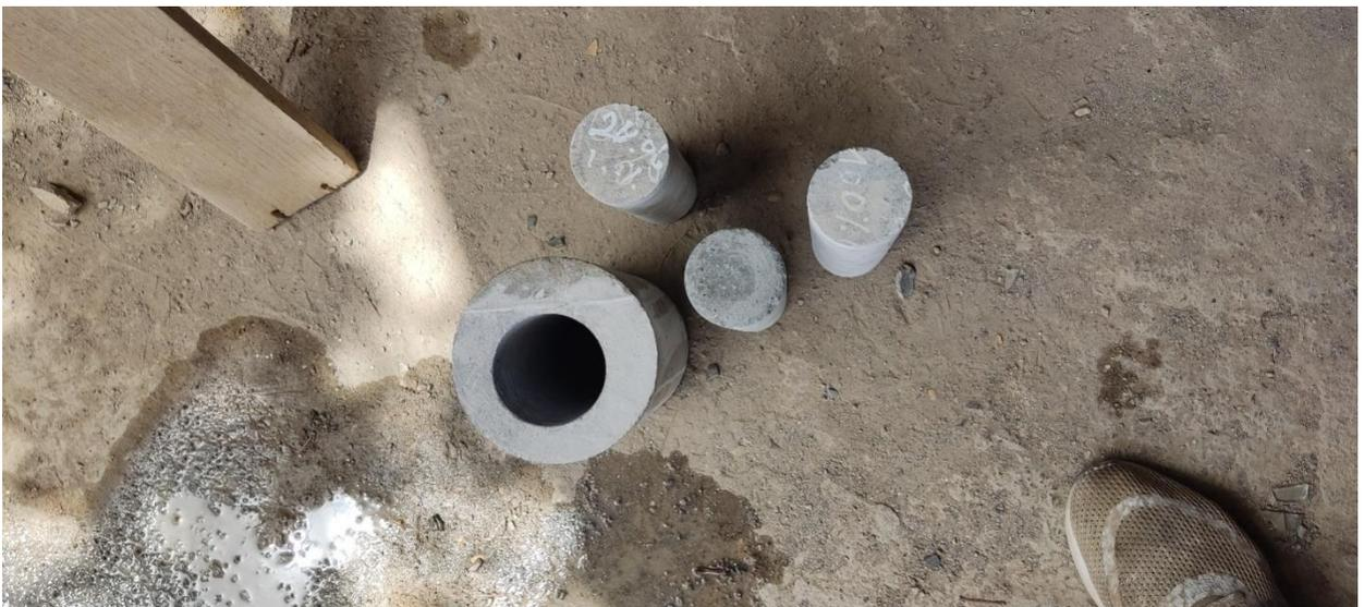
**Figure. IV. 12 :** les éprouvettes après le carottage
