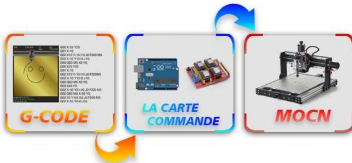
Figure 2.2: Le schéma synoptique de la solution choisie pour la réalisation de notre machine CNC.
