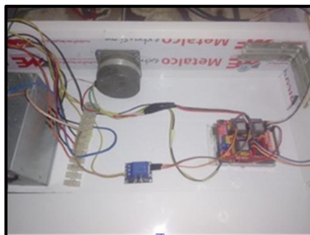
Figure 2.30 : Schéma de branchement du relais 5V à la carte CNC Shield.
