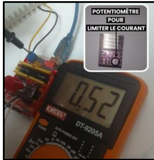
Figure 2.10: Limitation de courant sur Driver DRV8825 .
