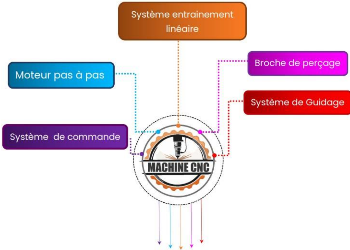
Figure 1. 6 : Schéma des constituants de la machine. [13]
