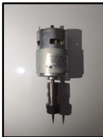
Figure 2.28 : Le moteur DC 12V de la broche.
