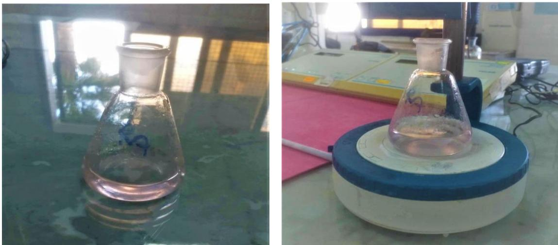
Figure IV 17: Virage coloré vers le rose pâle après la titration par  $\text{KMnO}_4$
