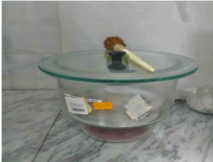
Figure IV-24: Un dessiccateur de laboratoire de la station.
