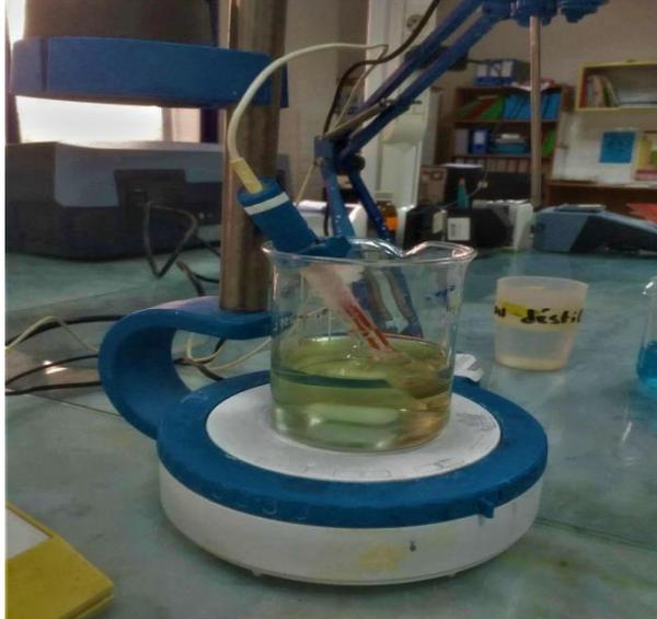
Figure IV 8: Obtenir la valeur de pH avant la titration par le HCL
