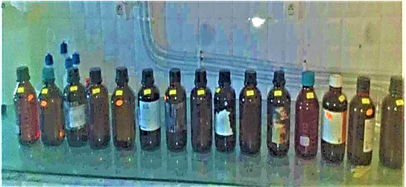
Figure IV 7: Simulation de la demande en chlore par 10 flacons de 1L au niveau de laboratoire.
