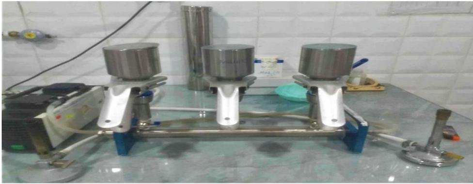
Figure IV-20: Le dispositif de filtration sous vide de pression.
