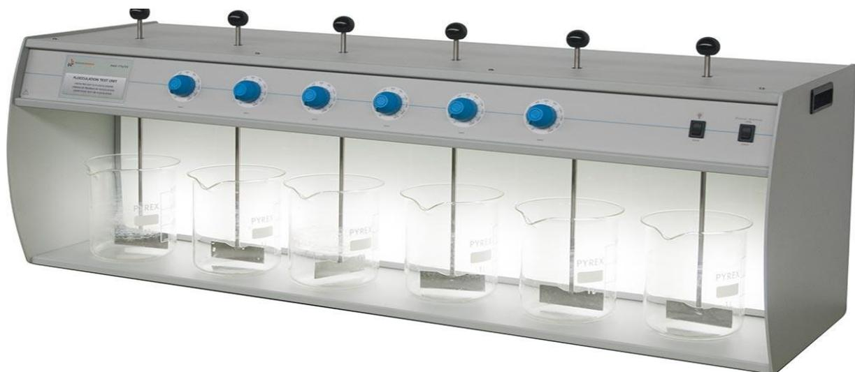
Figure IV 1: Un flocculateur.
