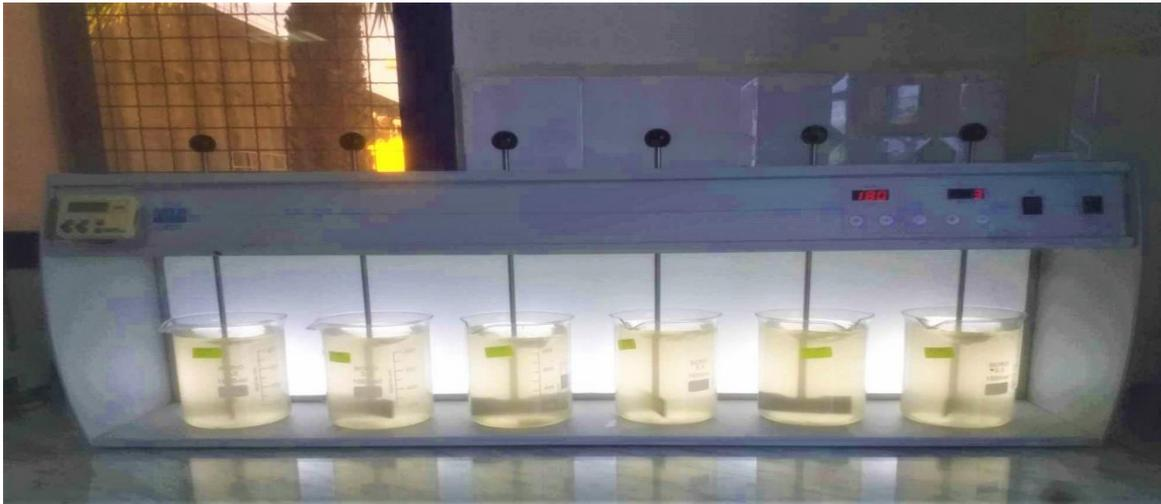
Figure IV 2: Simulation de jar-test au niveau de laboratoire par un floculateur.
