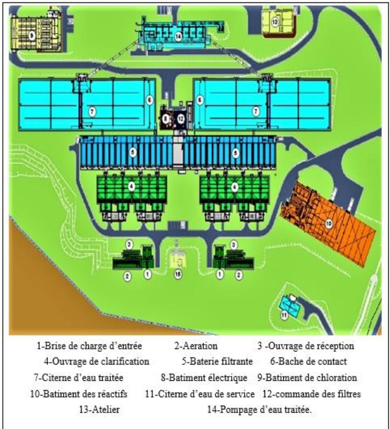
Figure II 7: Plan en 2D de la station de traitement KOUDIAT ACERDOUNE
