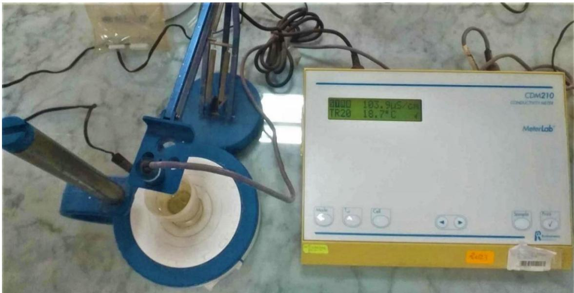
Figure IV-5: Un conductimètre.
