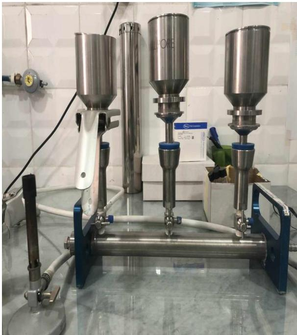
Figure IV-35: La rampe de filtration.
