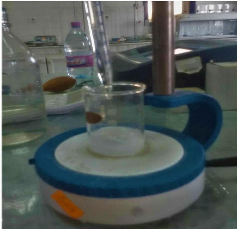
Figure IV-6: Titration pour la préparation de solution en chlore concentrée.
