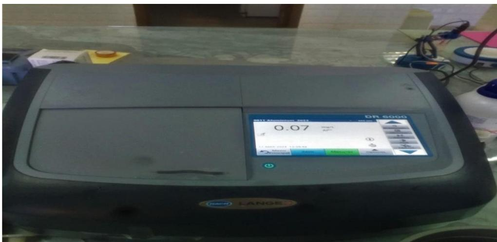
Figure IV-30: Un spectrophotomètre pour déterminer la concentration d'aluminium.
