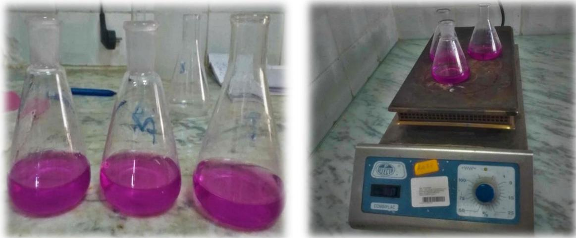
Figure IV-16: Les fioles des échantillons et l'ébullition par la plaque chauffante (expérience de MO).
