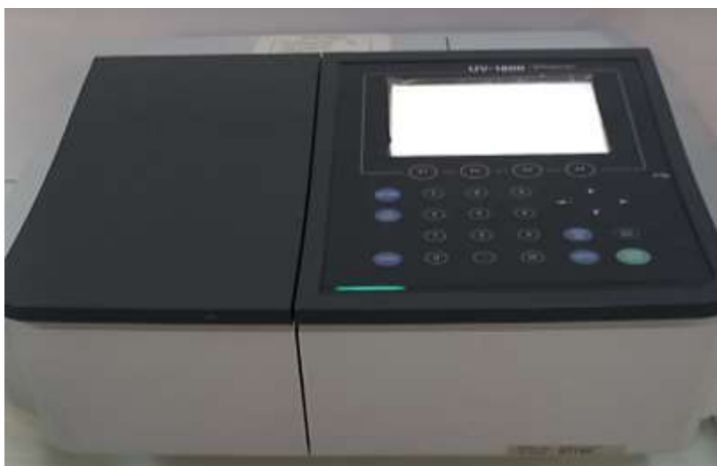
Figure II.1 Spectrophotomètre UV-Visible à double faisceaux de modèle « 1800 SHIMADZU ».
