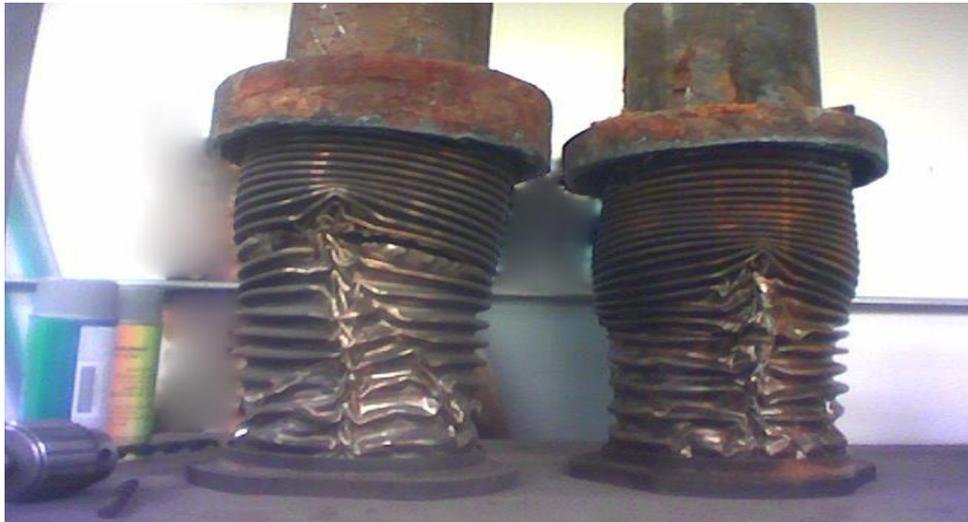
**Figure (II. 2) :** La détérioration des joints d'expansion suite à un aigu coup de bélier. [13]
