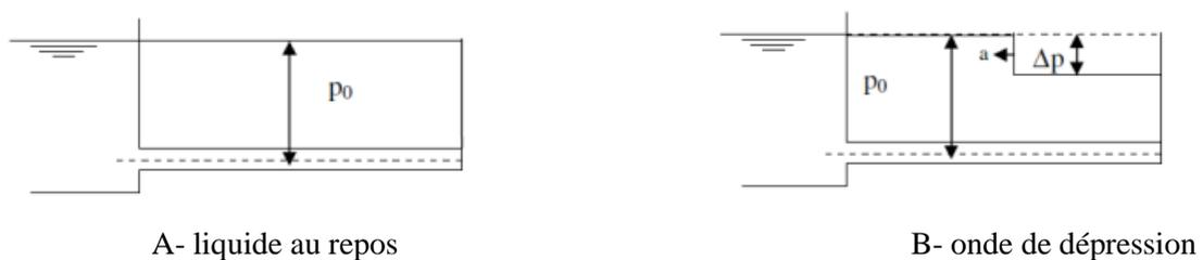
Figure (II. 8) : Ouverture brusque d'une vanne [20]
