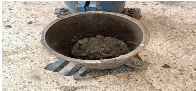
Figure III.14. Remplissage par couche des éprouvettes
