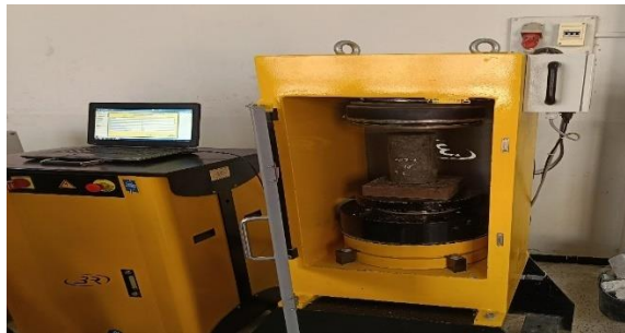
Figure III.20. L'écrasement des éprouvettes
