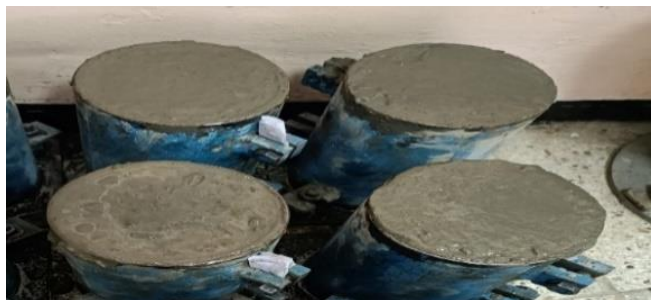
Figure III.15. Réalisation des éprouvettes
