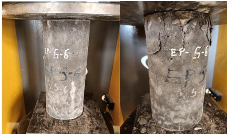
Figure IV.1. Mode de rupture des éprouvettes avec une répartition de (0.25-0.25-1)
