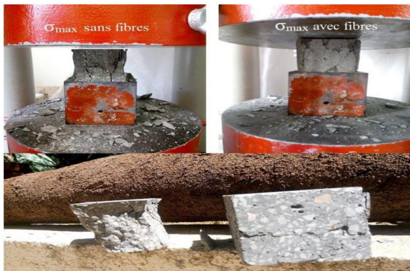
Figure II.20. Effet de l'ajout de fibres métalliques sur la détrition sous compression des BUHP.
