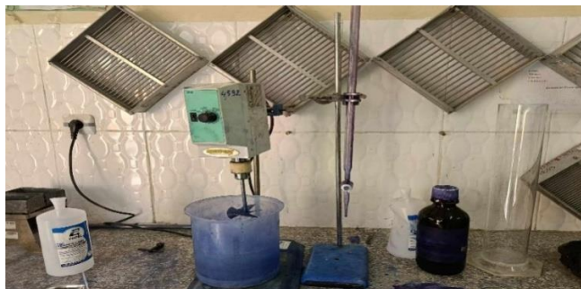
Figure III.5. Essai de bleu de méthylène
