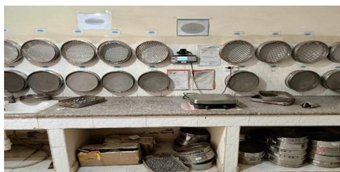
Figure III.6. Série des tamis pour l'essai analyse granulométrique
