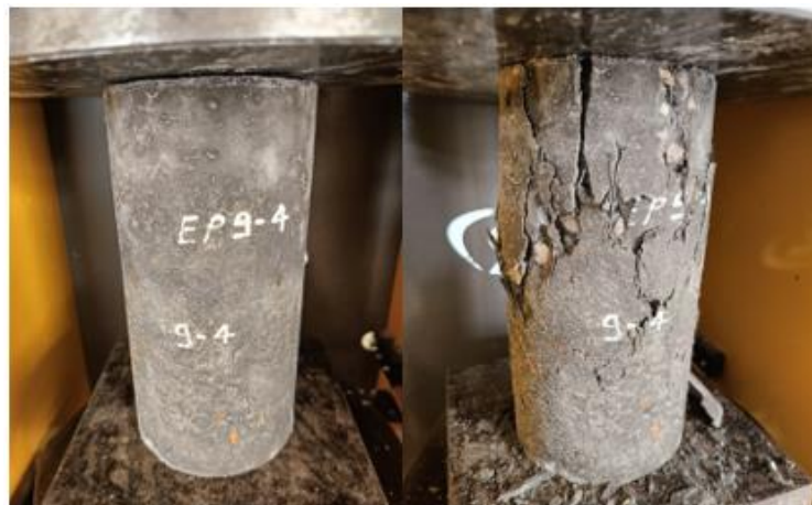
Figure IV.2. Mode de rupture des éprouvettes avec une répartition de (1-0.5-0.5)
