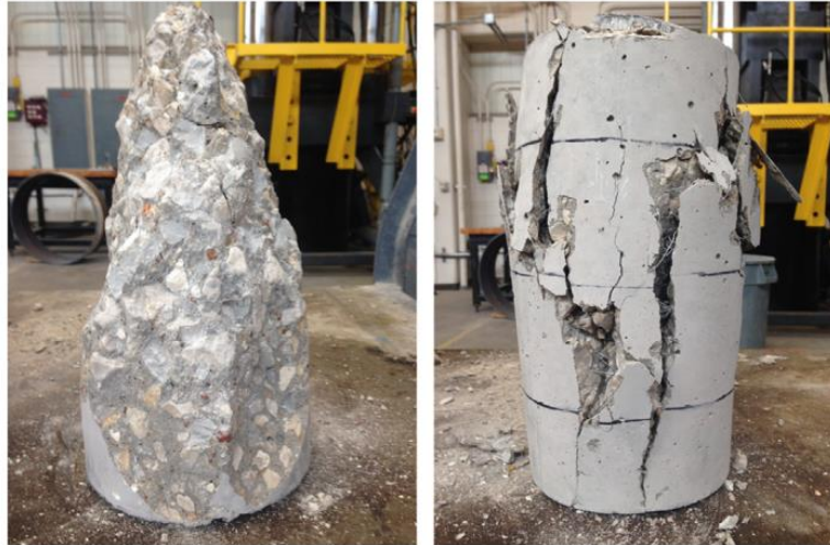
Figure II.7. Rupture par compression du béton ordinaire et béton fibré
