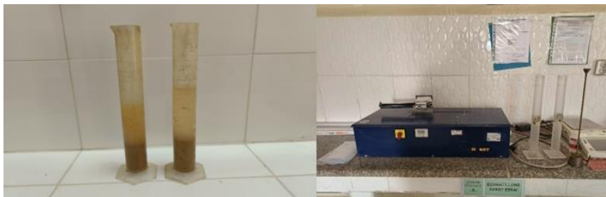
Figure III.4. Essai équivalent de sable
