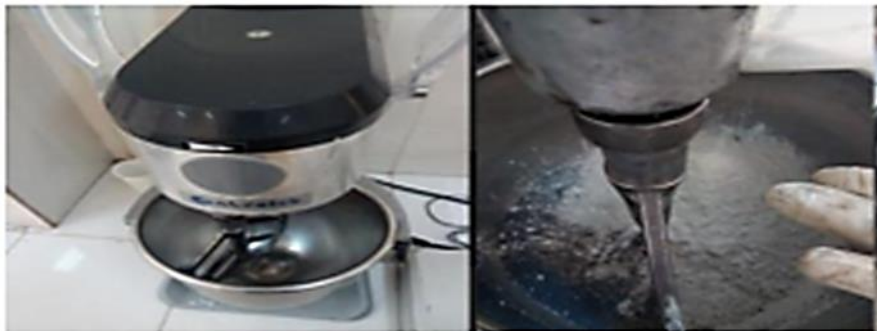
Figure III 8 : Essai de malaxage des constituants de béton de sable avec déchets.
