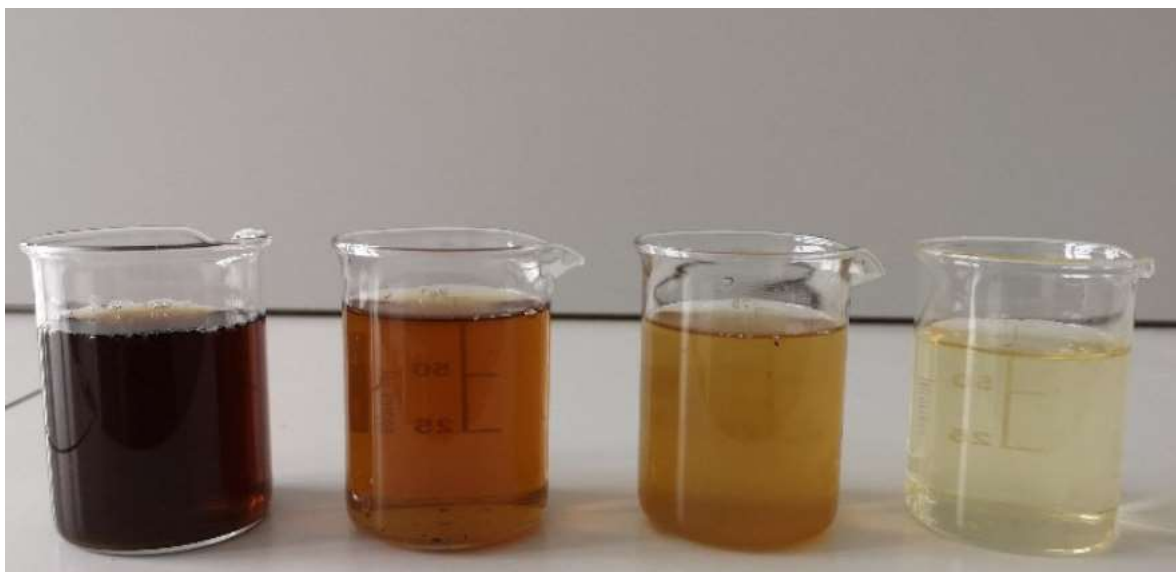
Figure II.6: Lixiviat avant et après traitement
