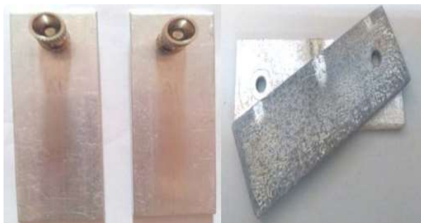
Figure III.6 : Etat d'électrode avant et après EC
