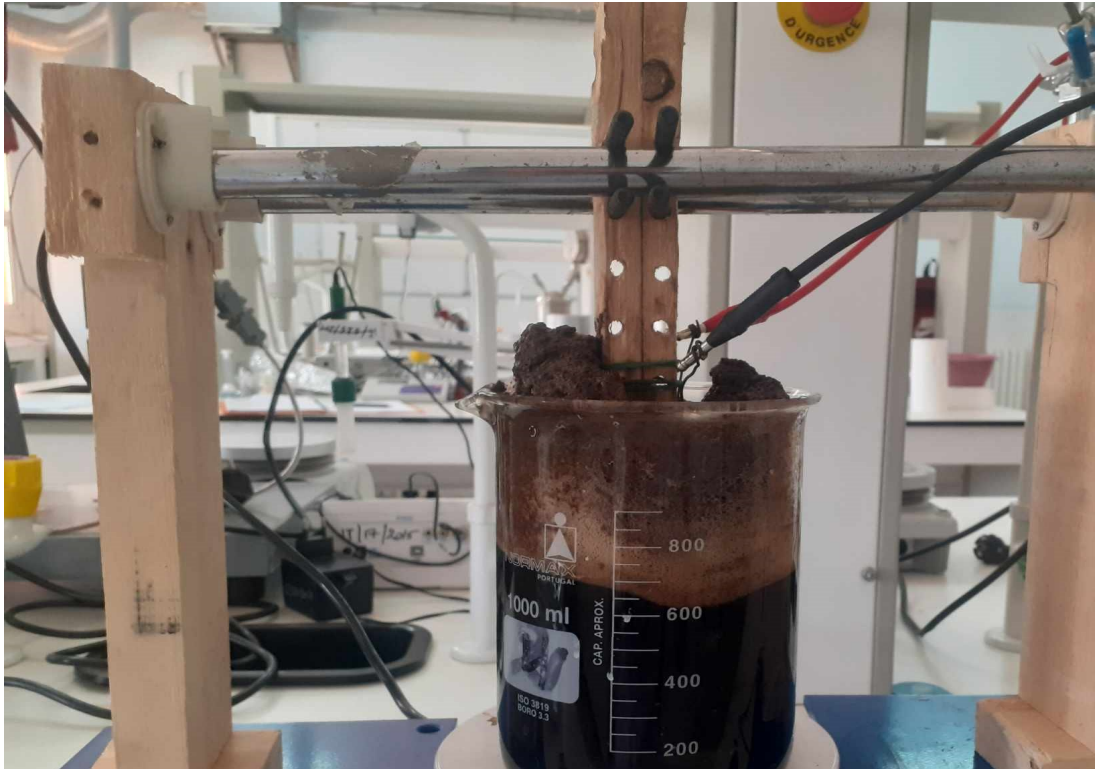
Figure III.5: Les flocs produits par l'EC
