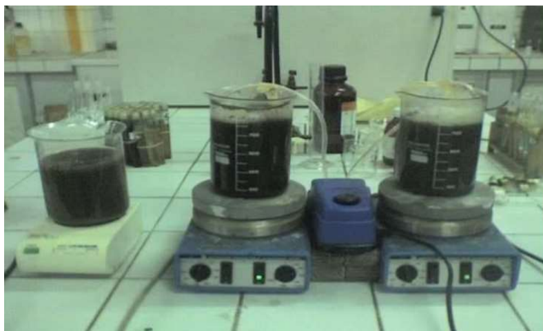
Figure II.3: Installation de traitement biologique utilisé
