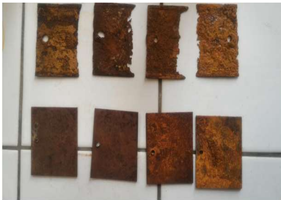
Figure III.3 : Dégradation des électrodes après traitement par l'électrocoagulation
