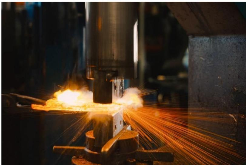
Figure I.16 : Processus de forgeage à chaud [20]
