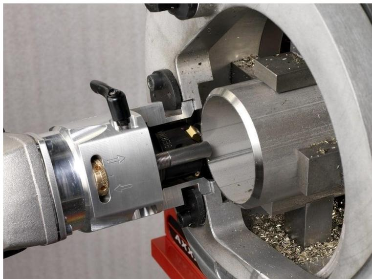
**Figure I.05 : L'opération de chanfreinage [9]**
