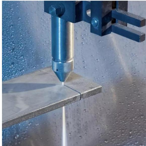
Figure I.21 : Processus de découpage par jet d'eau [25]
