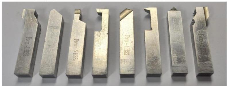
Figure II.09 : Outils de tournage en HSS
