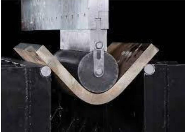
Figure I.15 : Méthode de pliage dans l'usinage par déformation [19]
