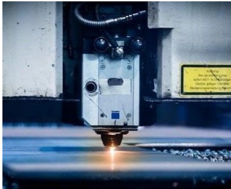
Figure I.20 : Processus de découpage au laser [24]
