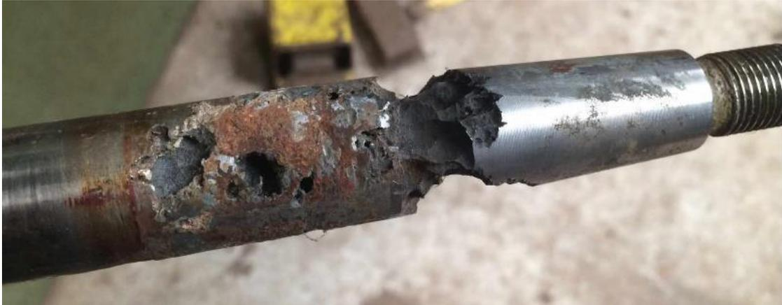
Figure III.03 : Le phénomène d'usure par corrosion [36]
