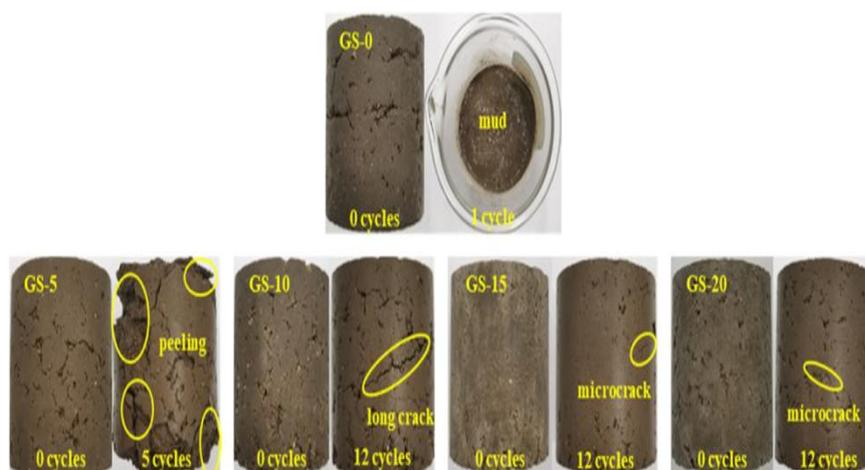
**Figure I.9** :L'apparence change des échantillons au cours des cycles WD. [Xichen Zhang et al, \(2022\)](#).
