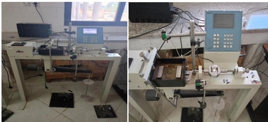
**Figure II.79:** Appareil de cisaillement.
