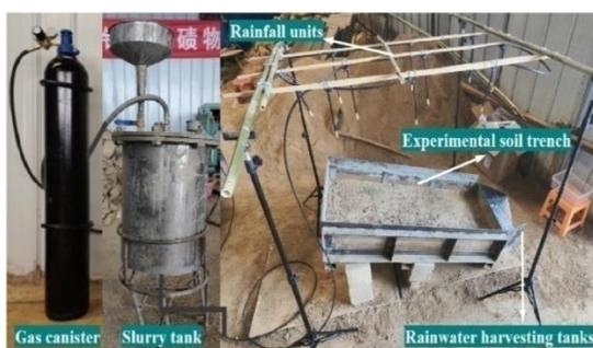
**Figure I.3:** Appareil de simulation de précipitations artificielles. Xing-long Feng et al, (2024).
