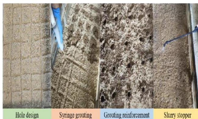
**Figure I.22 :** Simulation d'injection. Xing-long Feng et al, (2024).
