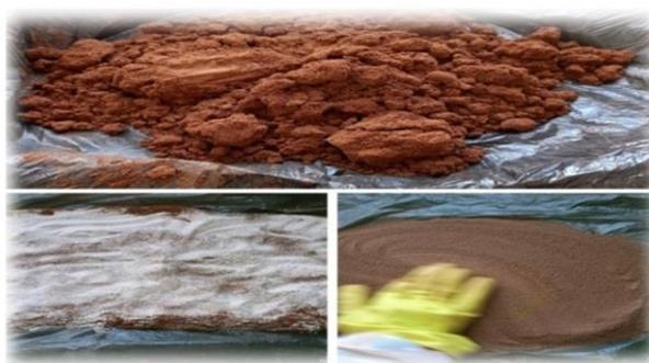
Figure II.69: Sol préparé pour l'essai œdométrique.
