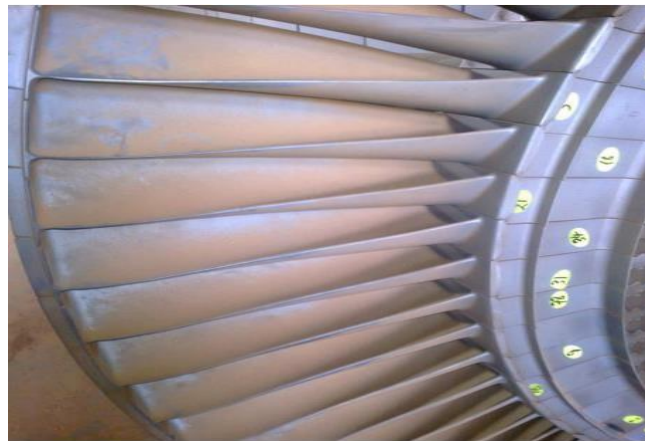
FIGURE I.23: VUE DES AUBES DE LA TURBINE (PRISE SUR SITE)
