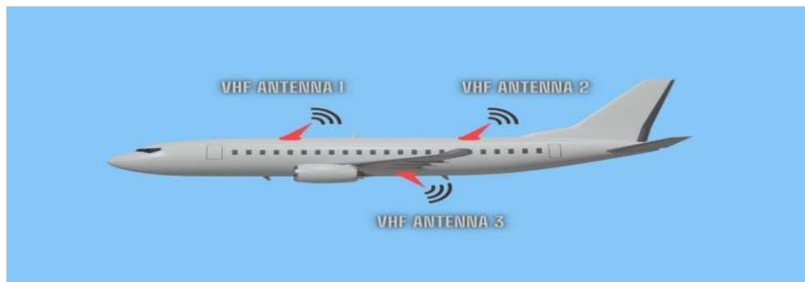
Figure 2.12 : Implantation des antennes VHF sur un avion
