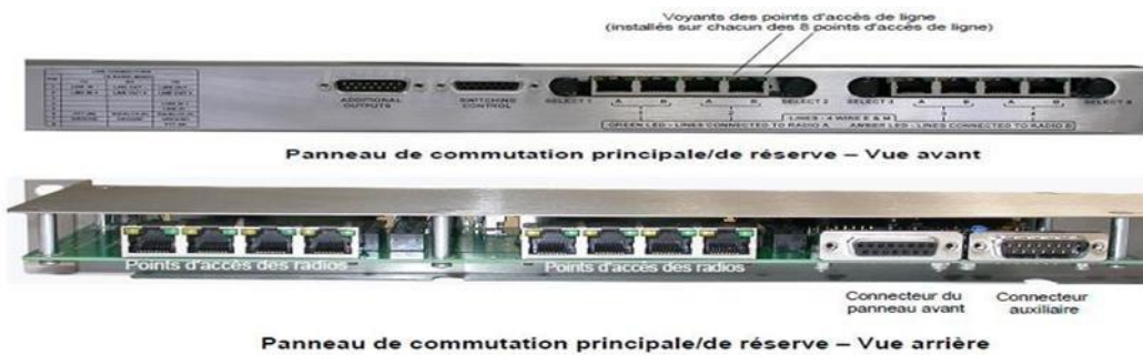
Figure 2.7 : Vue avant et arrière d'un panneau de commutation.
