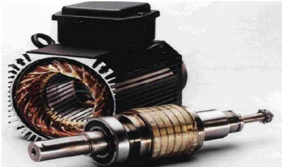
Figure 1.1. Stator et rotor d'une machine synchrone à aimants permanents
