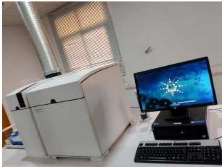
FIGURE 2.2: Spectrométrie de masse associée à un plasma d'argon à couplage inductif (ICP-MS).
