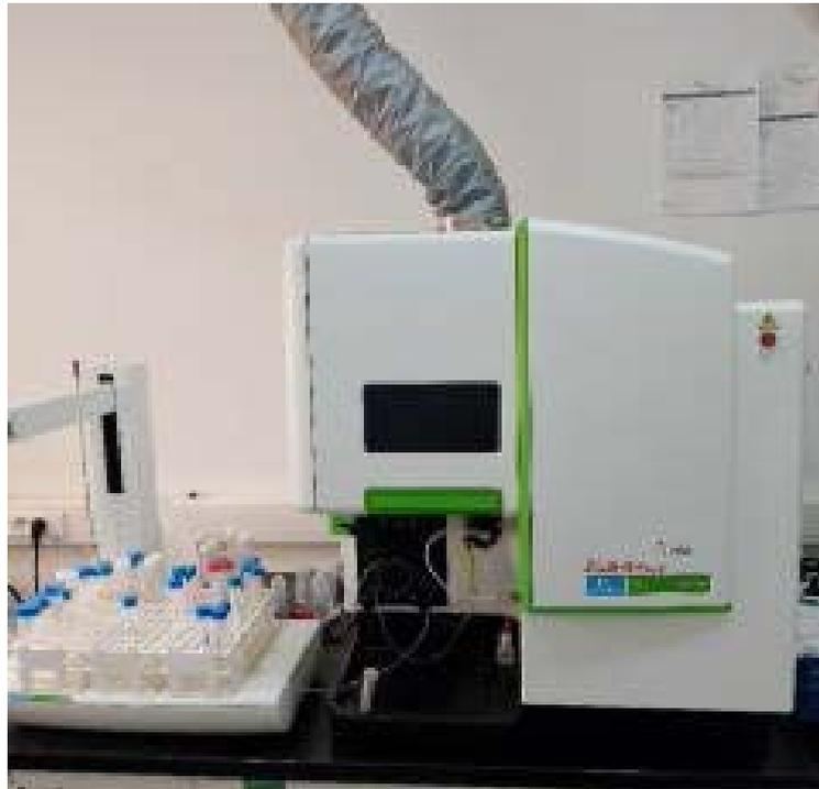
FIGURE 2.5: Spectroscopie d'Émission Optique (ICP -OES)
