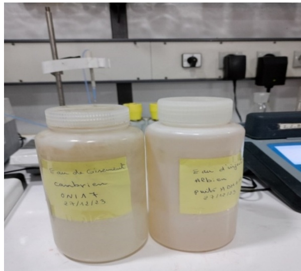
FIGURE 2.1: Les eaux de gisement (cambrien) et d'injection (albien) de la région de HMD
