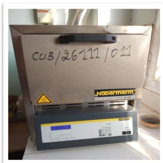
Figure II.2 : Four de laboratoire série L 5/11, T_{max} 1100 °C.
