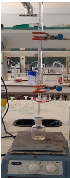
Figure 26: Montage utilisé pour la détermination de l'indice d'acide
