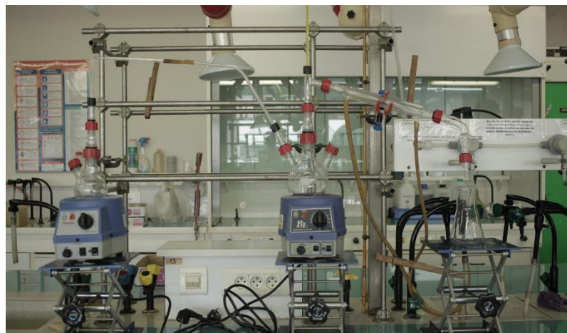
Figure 13: Montage d'entrainement a la vapeur
