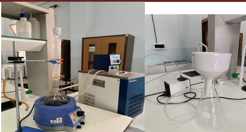
Figure II.20. Montage en Chauffage à reflux utilisé pour l'activation du charbon
