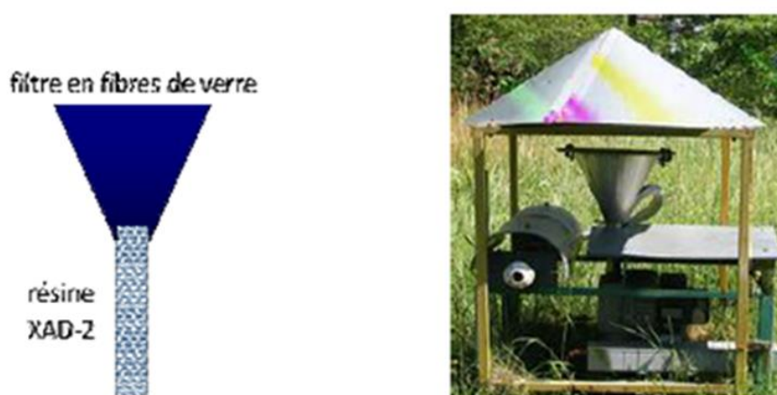
Figure. I.3. Filtre avec les portes filtre en TSP, PM 10 , PM 2.5 , PM 1 .
