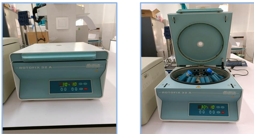
Figure (IV.2): la centrifugeuse (ROTOFIX 32 A)
