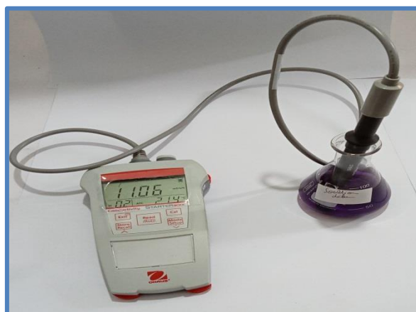
Fuguer IV.7 : conductimètre (STARTER300C)
