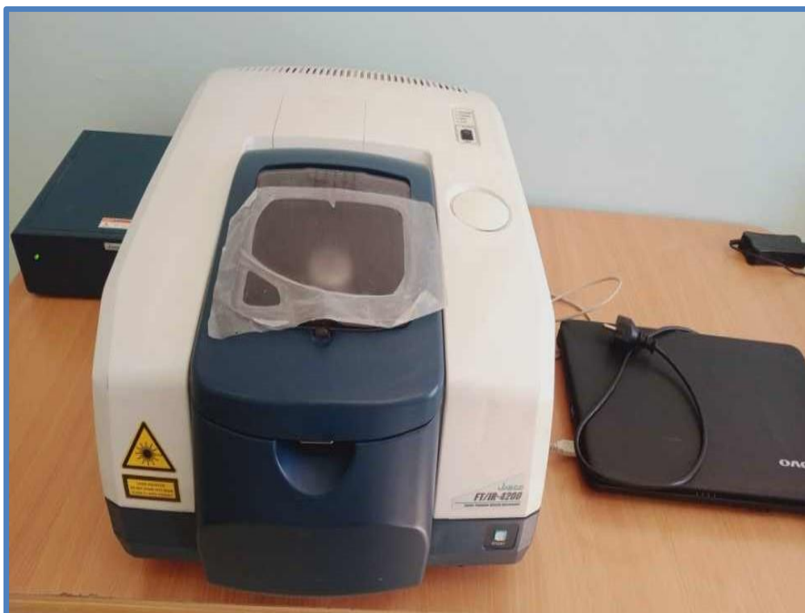
Figure IV.10: Appareil du spectromètre Infrarouge à Transformée de Fourier (IRTF)
