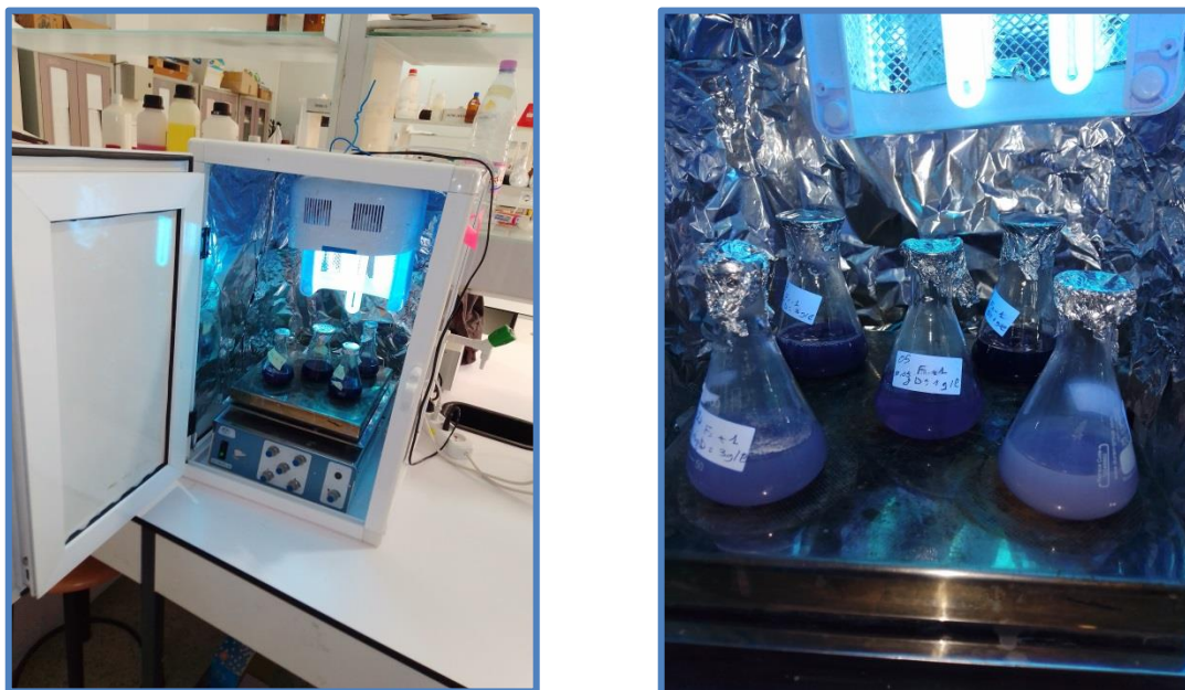
Figure IV.4; montage de l'expérience de photocatalyse.
