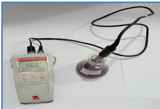
Figure (IV.6) : ph mètre (STARTER300)
