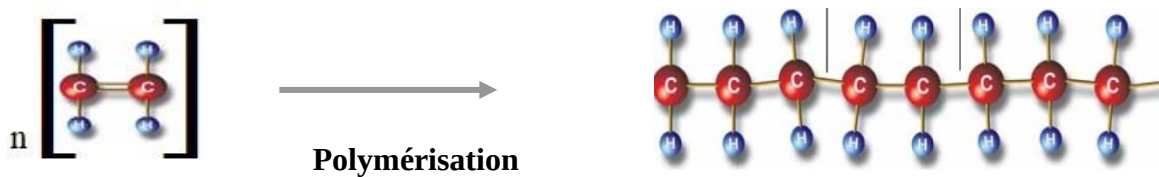
Figure 1: Polymérisation du PEHD
