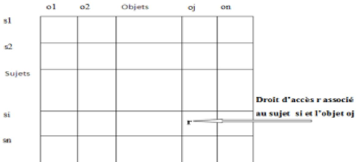
FIGURE 1.3 – exemple de matrice de contrôle d'accès
