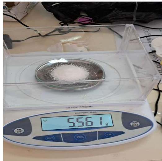
Figure III.3 : La quantité de PVA et d'eau distillée utilisée pour la préparation de la solution sur une balance numérique
