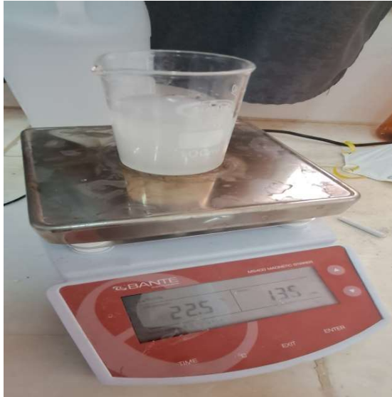
Figure III.5 : Agitation de la solution sur un agitateur magnétique pendant 21 heures.
