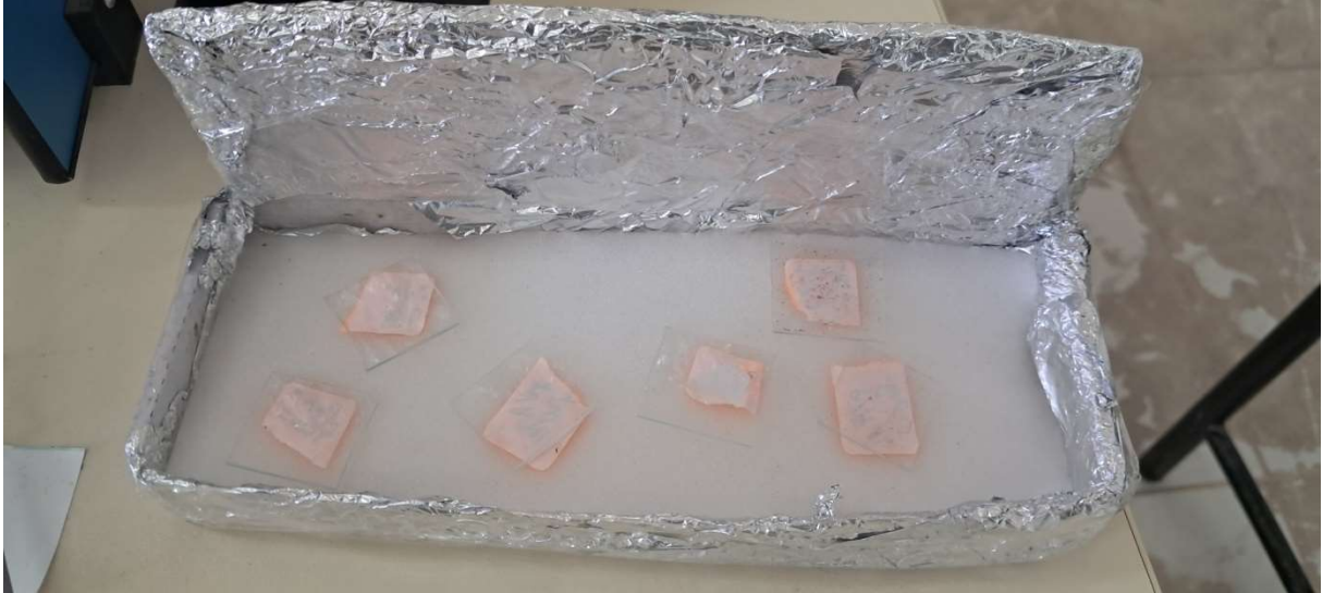
Figure III.8 : Séchage des échantillons ( \text{Fe}_2\text{O}_3 PVA et pur) enduits à température ambiante ( 25^\circ\text{C} ) pendant 24 h.
