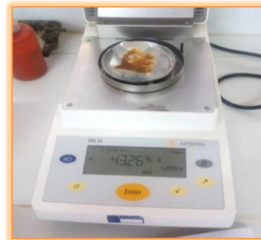
Résultat de la détermination de l'extrait sec total des fromages élaborés
