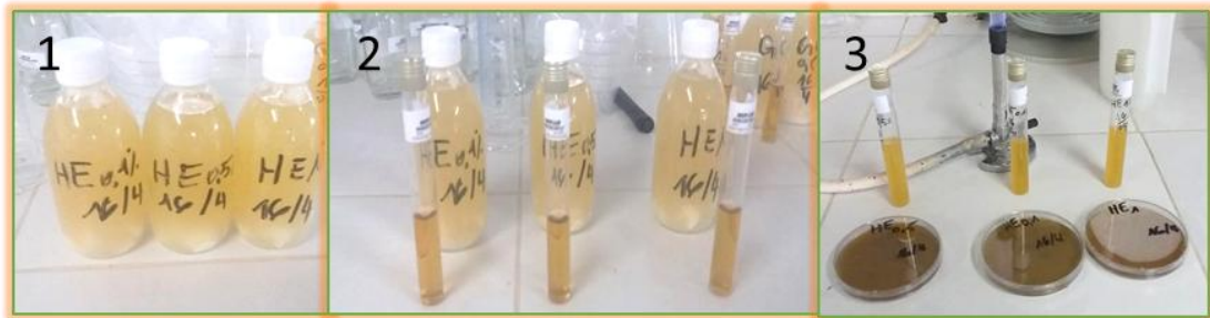
Résultats de la recherche de Salmonella (1. Etape de pré. Enrichissement / 2 Etape d'enrichissement / 3. Etape d'isolement)
