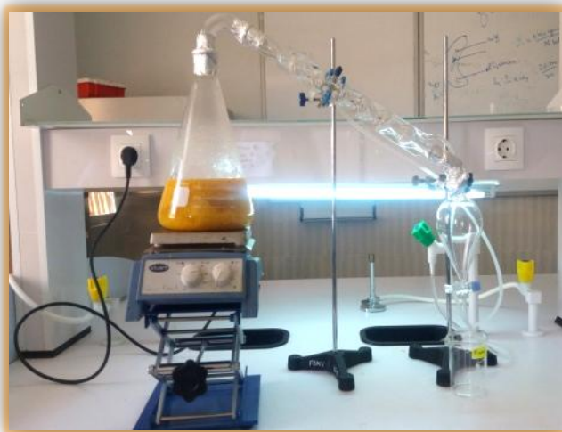
Extraction d'huile essentielle à partir du zeste d'orange par hydrodistillation
