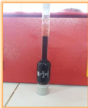
Résultat de la lecture de taux de matière grasse de fromage élaborés par un butyromètre
