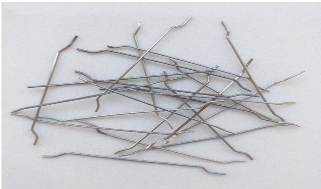
Figure 1. 9 Fibres d'acier Crochets aux extrémités [39].
