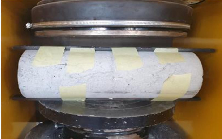
Figure 4. 12 Échantillon de BRFA au moment de l'essai de traction brésilien destructif.
