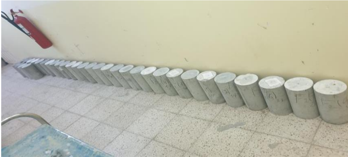
Figure 4. 10 Ensemble d'échantillons de BRFA avec une distribution aléatoire des fibres d'acier.
