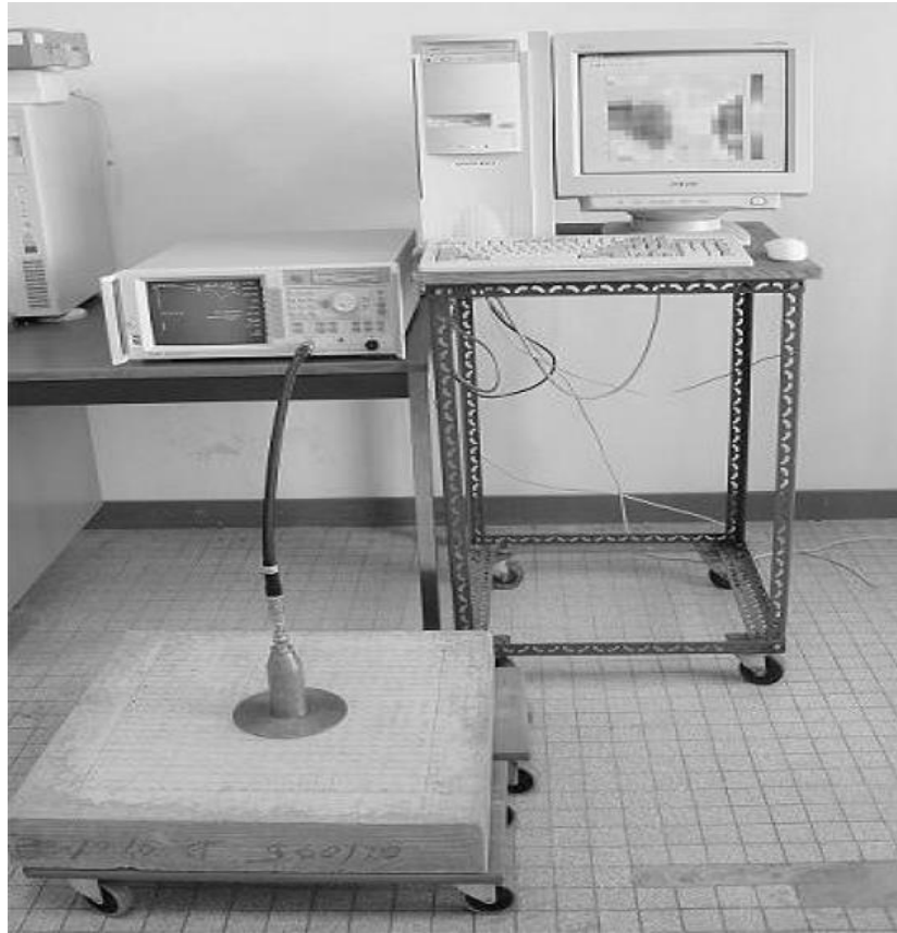
Figure 1. 18: Configuration expérimentale pour la réflectométrie par sonde coaxiale utilisée dans l'évaluation non destructive de la répartition des fibres dans le BRFA [74].
