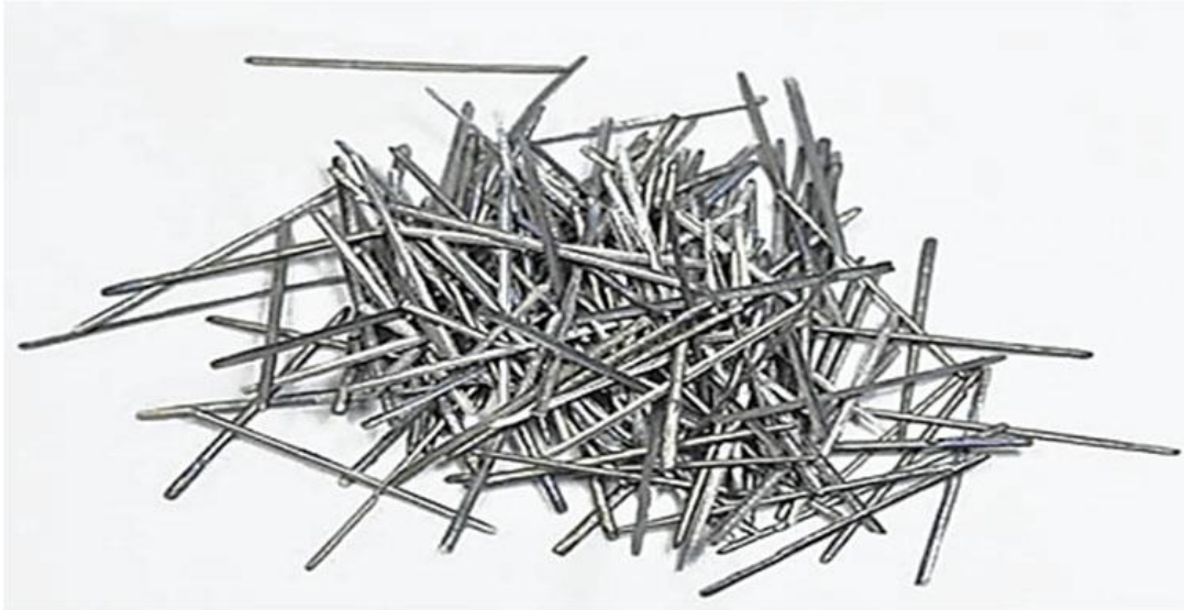
Figure 1. 6 Fibres d'acier droites [36].
