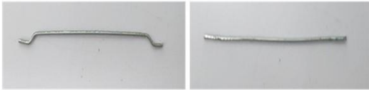
(a) Fibre d'acier avec extrémité crochetée.
