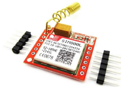
Figure XVII.11 : Module GSM SIM 800L. [18]
