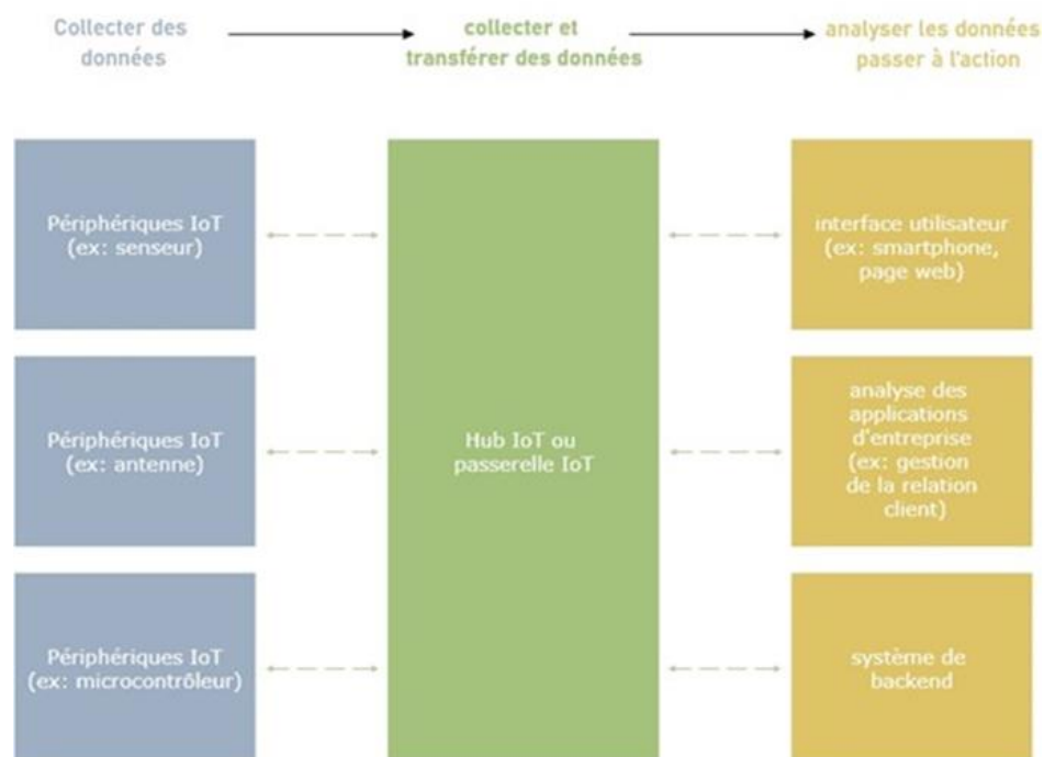
Figure I.1 : Schéma montre le fonctionnement et l'interaction d'un système IoT [2]
