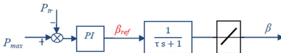
FIGURE 2.10 – Gestion de l'angle de calage (Pleine Charge).
