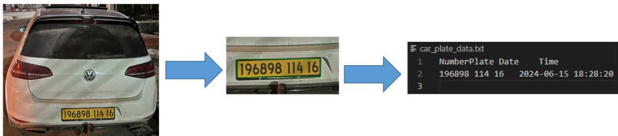
Figure III. 14: Détection du matricule et stockage dans un fichier.
