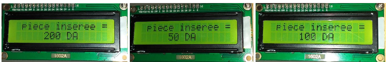
Figure III. 22: Affichage des pièces insérées.
