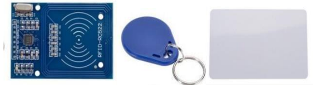
FigII.6 : Module RFID RC-522 et les deux TAGs (porte-clefs et carte) [w6]
