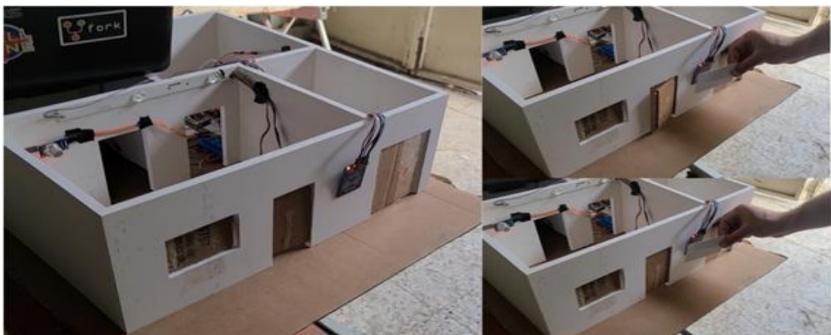
FigIII. 23: Ouverture et fermeture de la porte avec RFID
