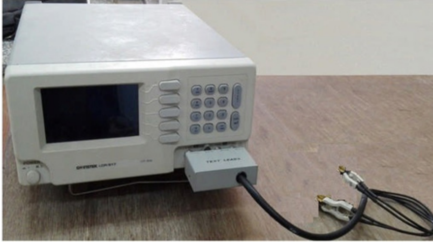
Fig III.11 : Impédance-mètre GwInstek LCR-817.
