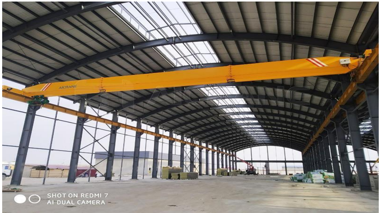
Figure IV-6 : pont roulant portique réalisé (20 T, 20 M)
