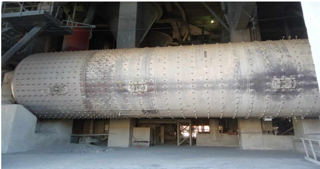
Fig.II.3 Broyeur à boulets de type "TIRAX UNIDAN R1M01"
