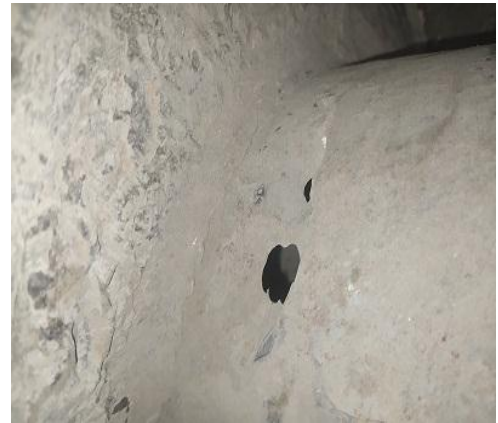
Fig.IV.2 Présence d'usure abrasive (Nés de vis de pompe transporteuse)
