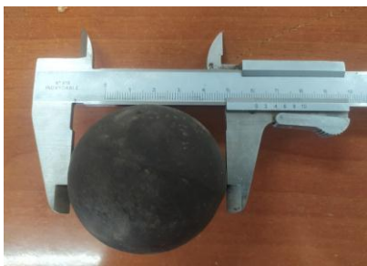
Fig.IV.3 Mesure des boulets de broyage 50 mm Avant le fonctionnement
