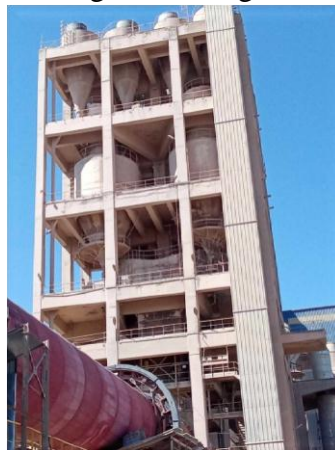
Fig.I.7 Ligne d'un préchauffeur à 4 étages de cyclones
