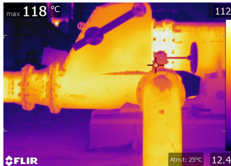
Fig.III.7 Température à la sortie de la pompe à vis
