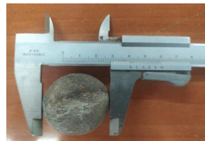
Fig.IV.4 Mesure des boulets après 4 mois de fonctionnement
