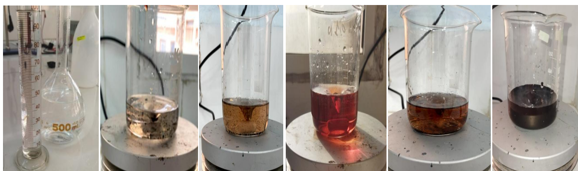
Figure II. 3 : Polymérisation par oxydation chimique de PANI et POMA.
