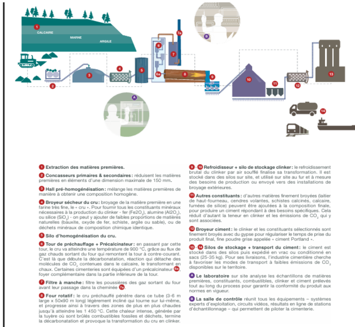
Figure I.4: Schéma récapitulant le processus de fabrication de ciment. [31]
