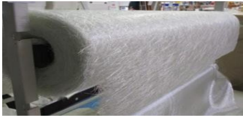
Figure I. 7: Fibre de verre sous forme mat [19].
