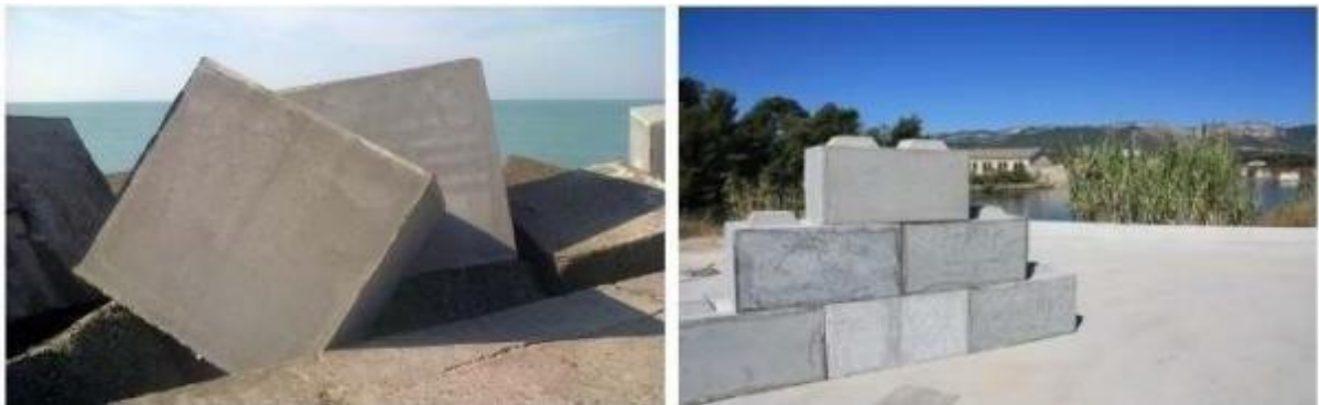
Figure II. 10: Blocs de bétons réalisés avec des sédiments non-immérgeables traités (droite : Port de Dunkerque, gauche : Rade de Toulon)
