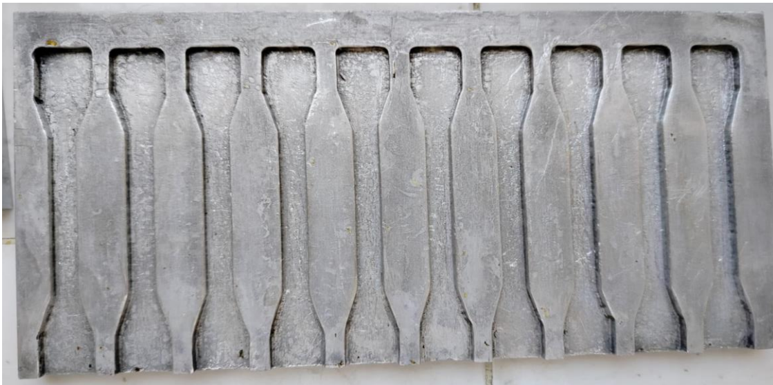
Figure II - 18: Moule métallique suivant la norme ISO 527-2
