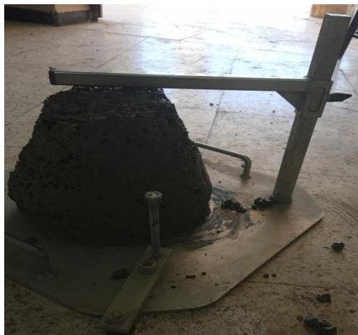
Figure II - 10: Essai d'affaissement au cône d'Abrams.
