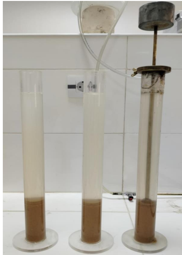
Figure II - 8: Test d'équivalence de sable.
