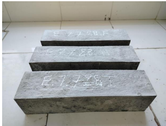
Figure II - 12: éprouvette prismatique du béton 7*7*28.
