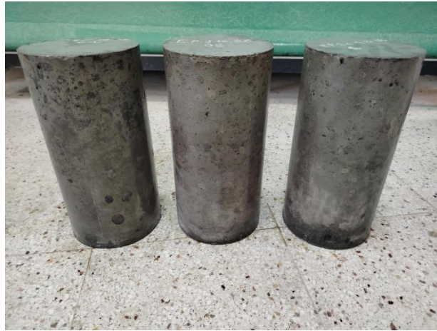
Figure II - 11: éprouvette cylindrique du béton 16*32.
