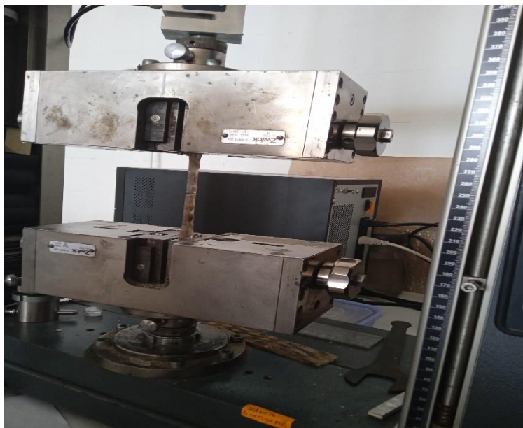
Figure II 26 : Essai de traction sur l'éprouvette en résine renforcée
