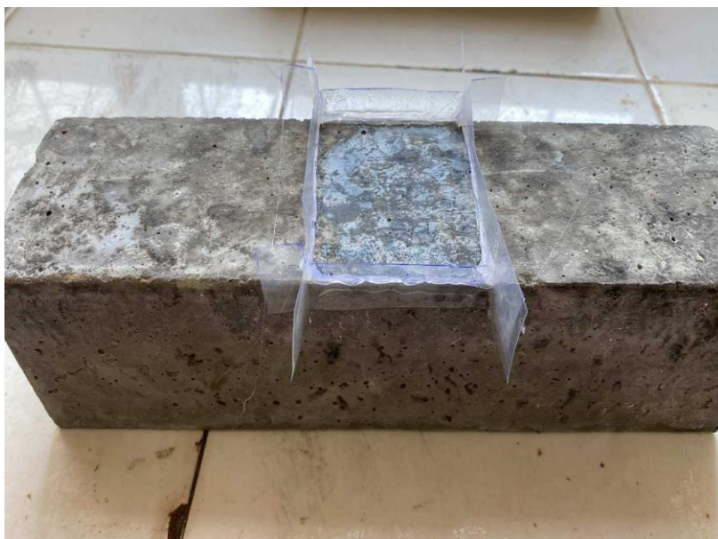
Figure II 24: Éprouvette de béton et résine (à l'état frais).
