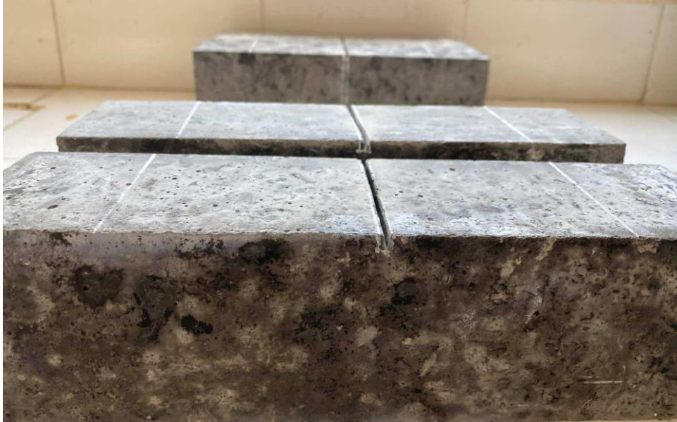
Figure II 23: Les éprouvettes fissurées.
