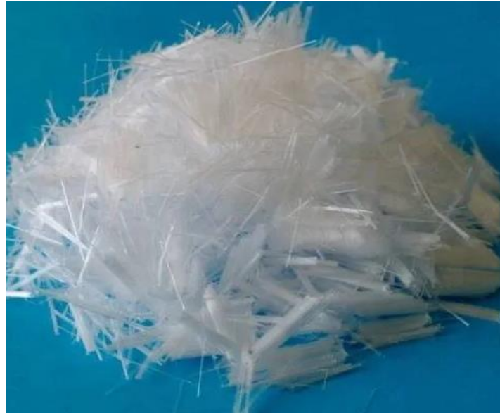
Figure I 6: Morphologie et structure dans les fibres de Polyéthylène utilisées dans les composites.
