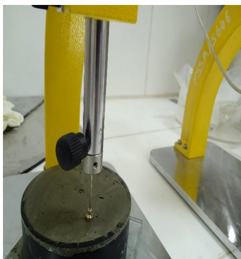
Figure II 11 : Essai de fin de prise.
