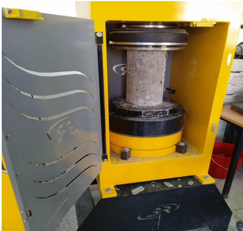
Figure II 27 : Essai de compression sur éprouvette de béton durci 16 \phi 32cm.
