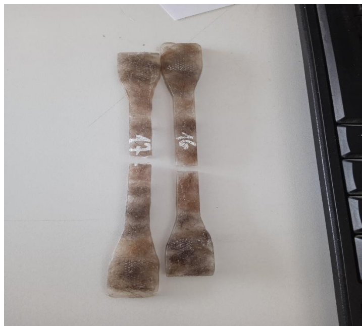
Figure III 1: Éprouvettes en résine renforcée soumises à des efforts de traction.
