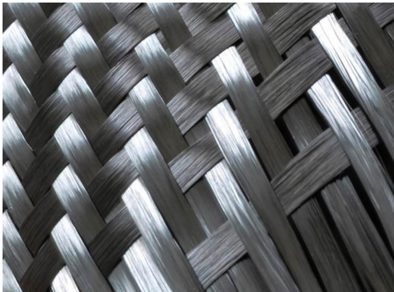
Figure I 4: Morphologie et structures des fibres de carbone utilisées dans les composites.
