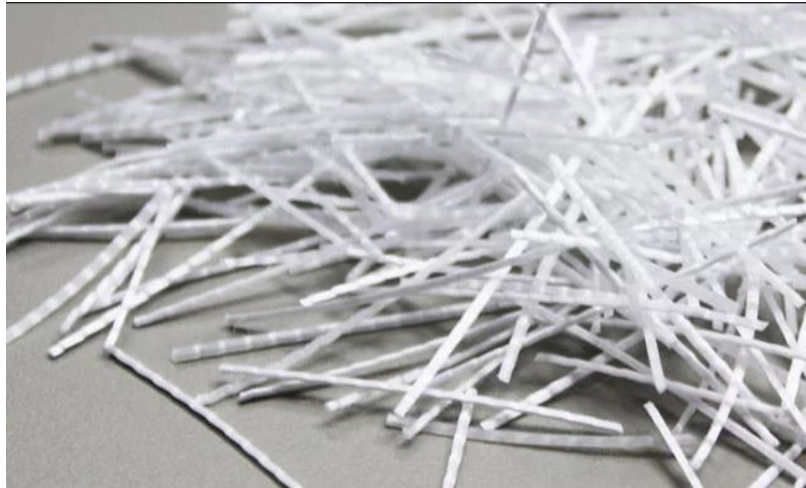
Figure I 7: Morphologie et structure des fibres de Polypropylène utilisées dans les composites.
