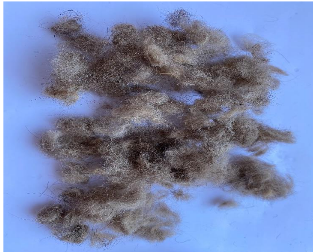
Figure I 5: Morphologie et structure des fibres de poil de chameau utilisées comme renfort naturel dans les matériaux composites.
