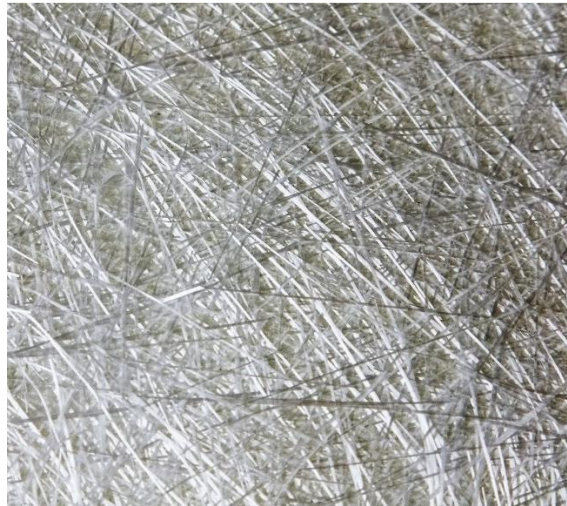
Figure I 3: Morphologie et structure des fibres de verre.
