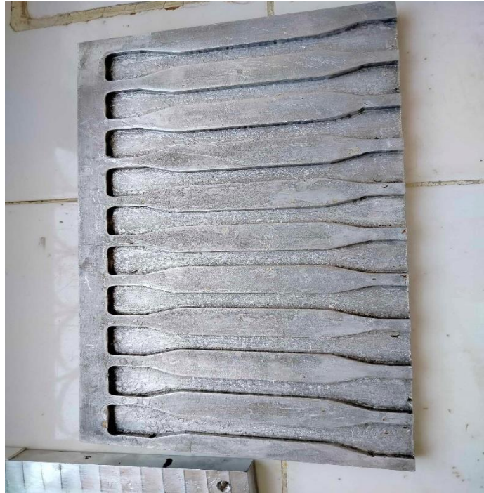
Figure II 20 : Moule des éprouvettes de forme ban dog.
