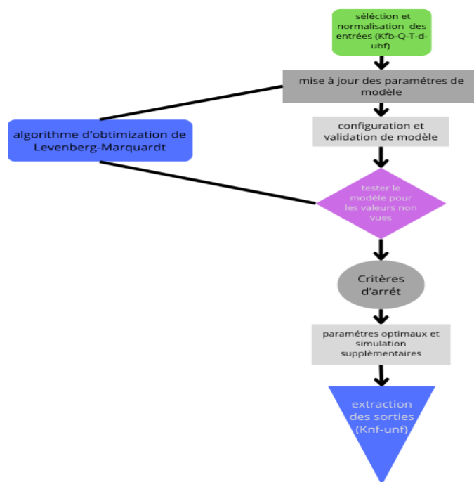
Figure III. 5: Schéma des étapes de l'algorithme de Levenberg Marquardt :
