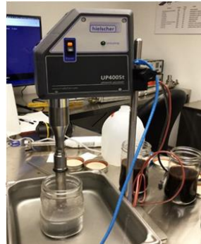
Figure I. 2 : UP400St Homogénéisateur Ultrasonique pour la Production de Nanofluides. [9]
