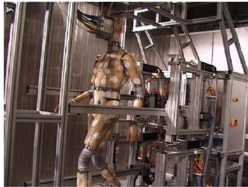
FIGURE II-36 : SAM, MANNEQUIN ARTICULÉ THERMIQUE [27]
