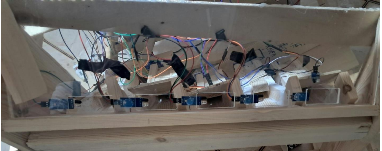
Figure 36: monnayeur en plaque plexiglas et un capteur dans chaque trou
