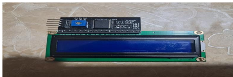
Figure 21: branchement de l'interface I2C et l'afficheur LCD 16*2
