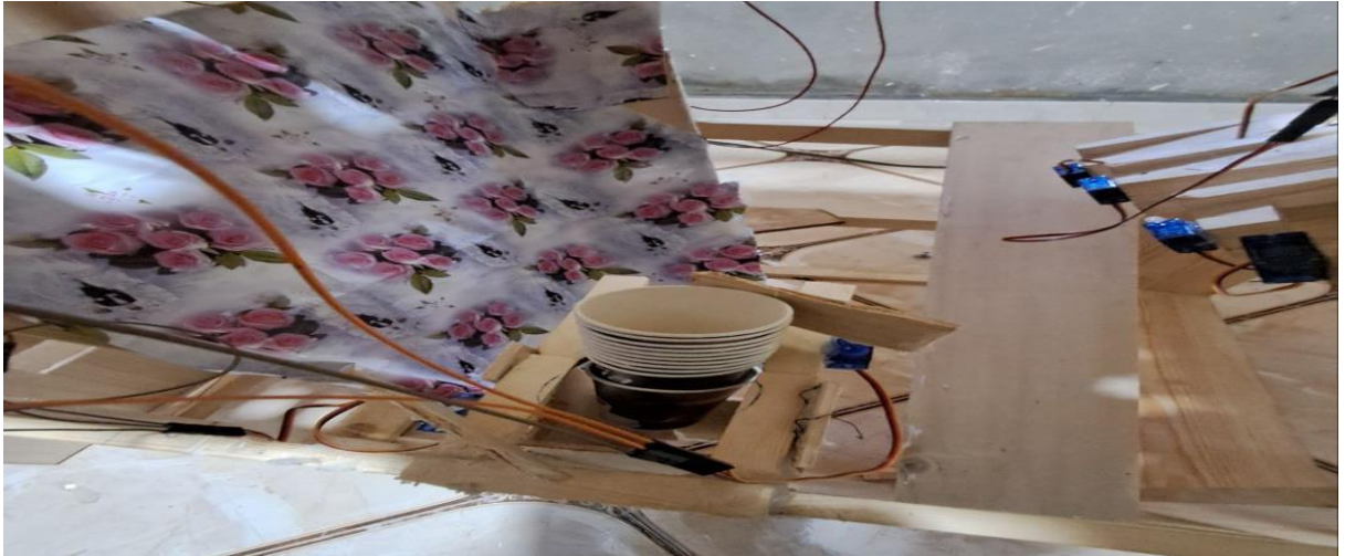
Figure 38: système de libération automatique des gobelets
