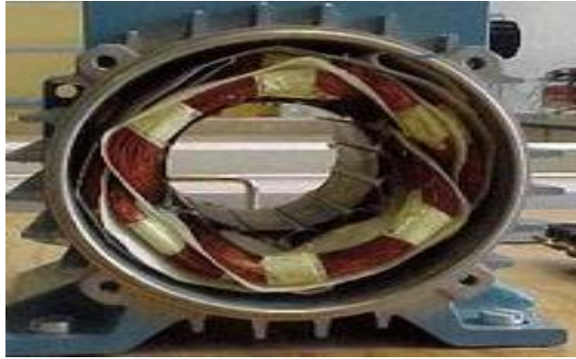
Figure.I-3 : Stator d'un moteur asynchrone triphasé.[4]
