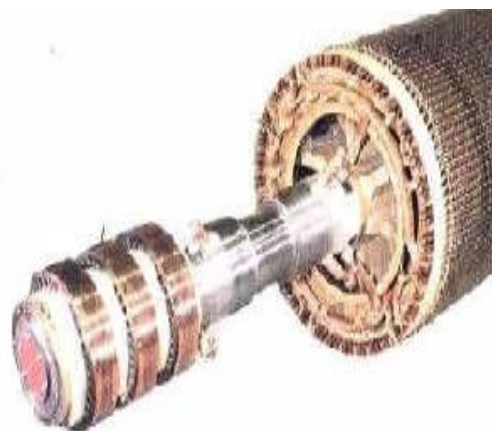
Figure.I-5 : rotor bobiné [4]
