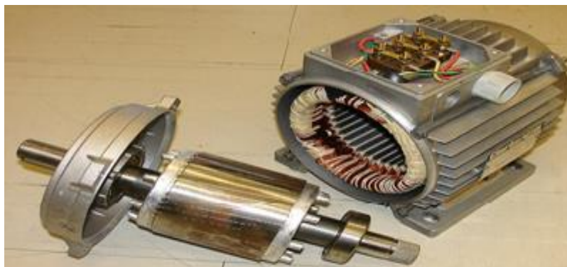
Figure.I-1 : Moteur asynchrone à cage d'écureuil.[4]
