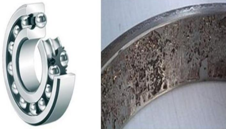
Figure.I.20. Défaits des mécaniques (roulements)[17].
