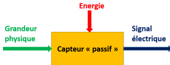
Figure 19 : Schéma bloc d'un capteur passif [32]
